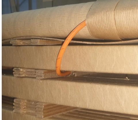
Rys. 5.16. Widok wyprowadzenia światłowodu z uzwojenia typu cewkowego [Oprac. własne]
