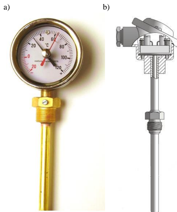
Rys. 3.10. Termometry do pomiaru temperatury oleju pod pokrywą: a) ze wskaźnikiem temperatury, b) z głowicą przyłączeniową [123, 125]
