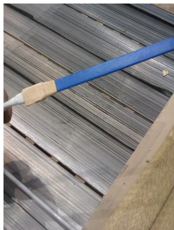
Rys. 3.2. Widok montażu czujnika Pt100 w rdzeniu transformatora:
