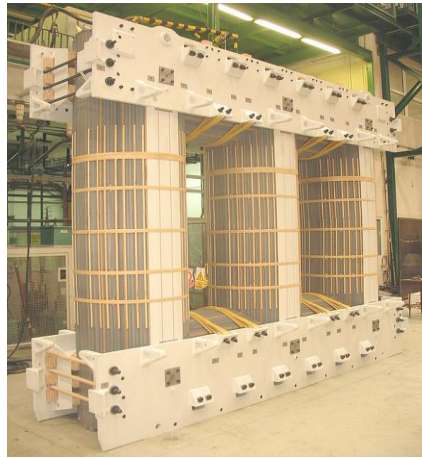
Rys. 3.1. Widok rdzenia trójkolumnowego transformatora blokowego 290MVA/420kV [Oprac. własne]
