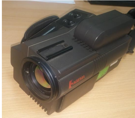
Rys. 3.13. Kamera termowizyjna Agema [Oprac. własne]
