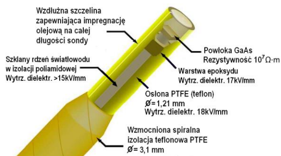
Rys. 4.3. Wykonanie przewodu światłowodowego przeznaczonego do pomiaru temperatury [105]
