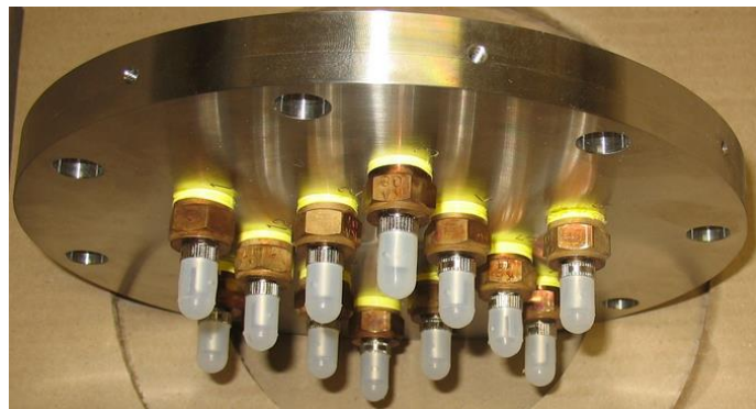
Rys. 5.6. Widok płyty z przepustami [Oprac. własne]
