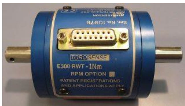
Rys. 3.1.5. Zastosowany przetwornik momentu E300 RWT1 produkcji TorqSense.
