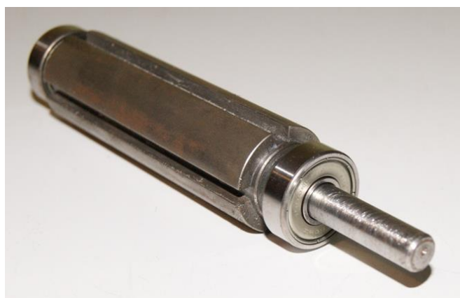
Rys. 4.5.1. Elementy wykonanego prototypu silnika: a) stojan z nawiniętym nowym uzwojeniem, b) wirnik z naklejonymi magnesami trwałymi.
