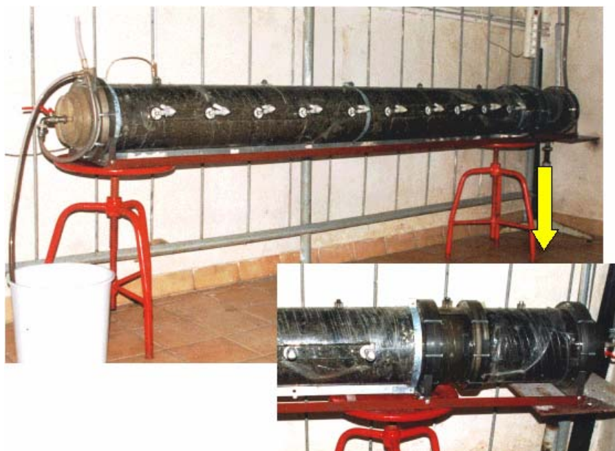
Fot. 1 Reaktor do badań denitryfikacji in situ
