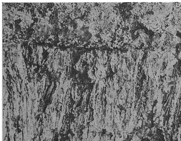
Rys. 16. Spoiwo w złym gatunku dzieli się przy zginaniu, wykazując na mikrografii wyraźne szczeliny międzykrystalitowe.
