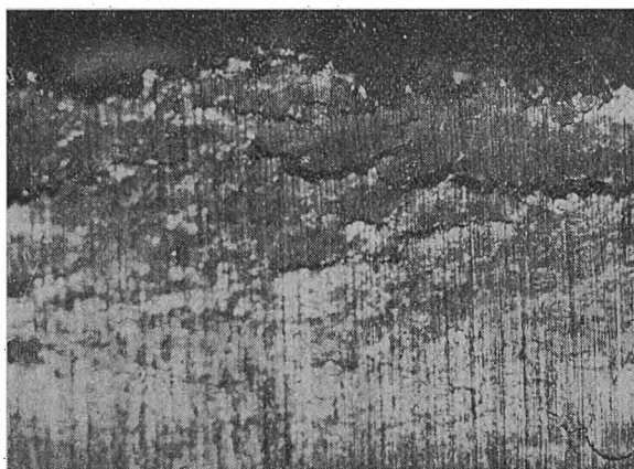
Rys. 14 i 15. Spoiwo w złym gatunku dzieli się przy zginaniu, wykazując na mikrografii wyraźne szczeliny międzykrystalitowe.
