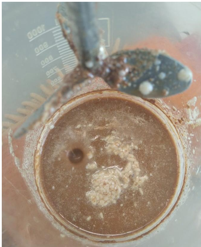
Rysunek 19. Flotujące cząsteczki pojawiające się podczas dozowania \text{H}_2\text{O}_2 w próbie E1.3b.
