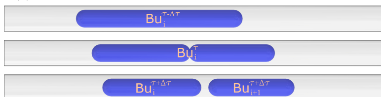
(b) Schemat algorytmu rozpoznania rozpadu bąbla parowego
