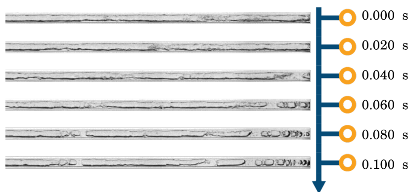
(a) Kolejne klatki rozpadu bąbla parowego
