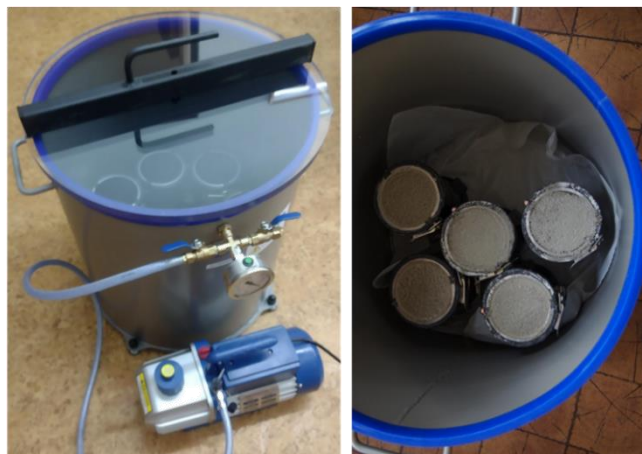
Rys. 1. Komora próżniowa wraz z pompą oraz próbki betonowe w formach przed dekompresją
