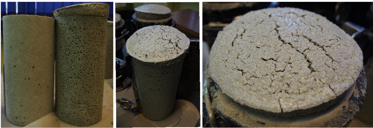
Rys. 2. Zwiększenie objętości i porowatości próbki betonowej w wyniku dekompresji
