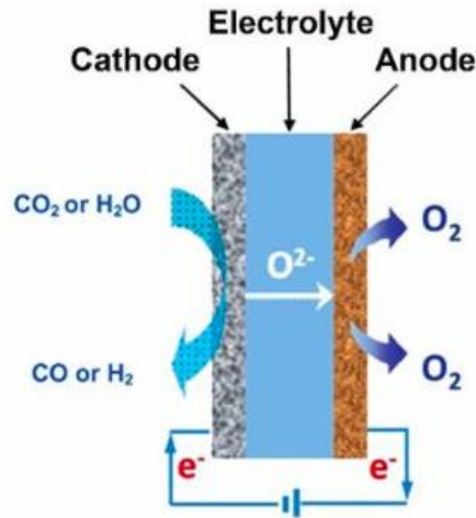
Rys. 2. Zasada działania elektrolizera stałego SOEC [2]
