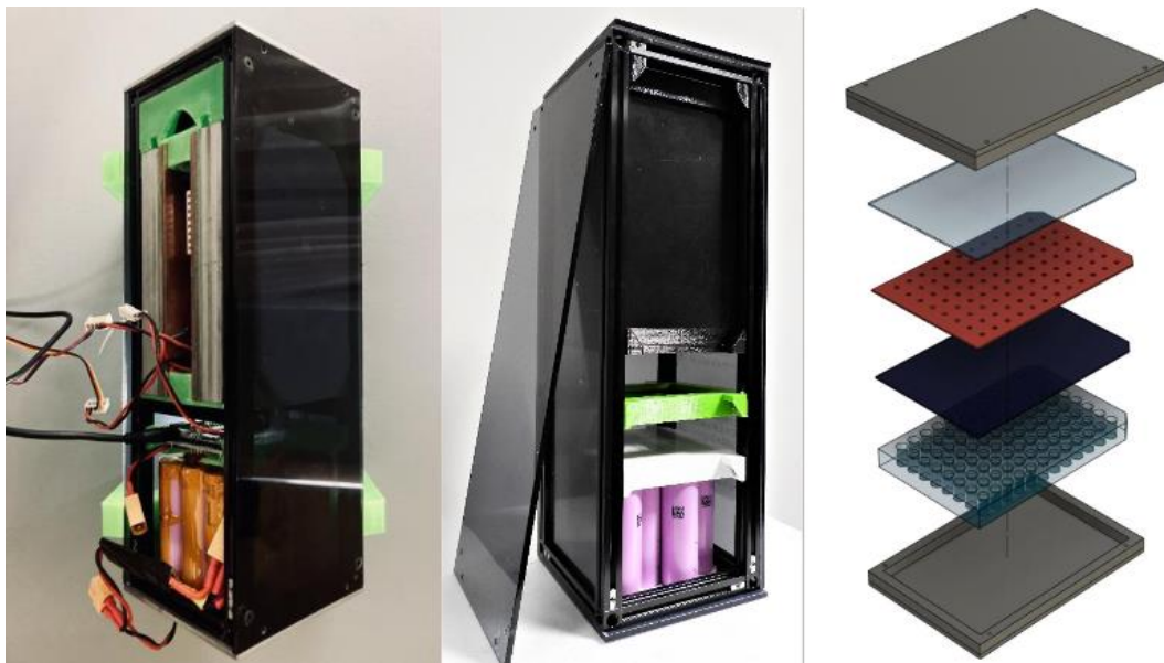
Rys. 1. Konstrukcja pierwszej iteracji projektu AMBER oraz schemat modułu uszczelniającego przestrzeni operacyjnych
