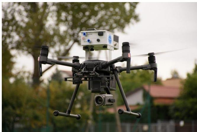
Rys. 2. SOWA na pokładzie drona Matrice 210 RTK V2 DJI
