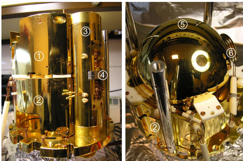
Rys. 14. Zdjęcia częściowo zdemontowanego analizatora \alpha -SDA. Cyframi oznaczono: 1 – obudowę górnej półkuli, 2 – obudowę dolnej półkuli, 3 – kolumnę wejściową, 4 – deflektor magnetyczny, 5 – wewnętrzną okładkę górnej półkuli, 6 – płytki korekcyjne. [45, 54]
