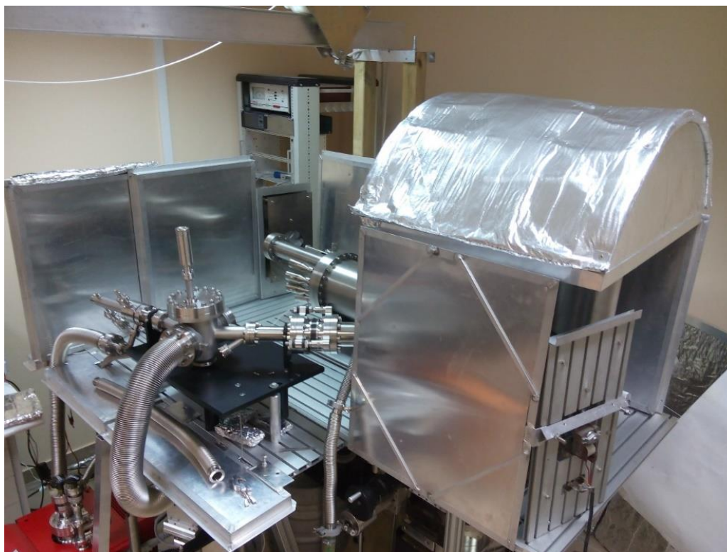
Rys. 38. Widok rozbudowanej konstrukcji obudowy do wygrzewania systemu DEEM w trakcie demontażu po procesie wygrzewania. [praca własna]
