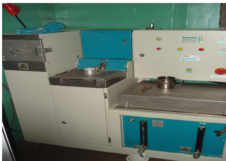
Rys. 1.19. Ekstraktor – urządzenie do wykonywania ekstrakcji MMA
