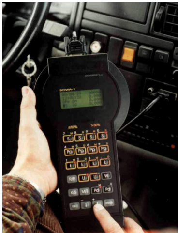
Rys. 4.8. Przykład urządzenia pomiarowego (rejestrator SOWA-1 zainstalowany w pojeździe)
