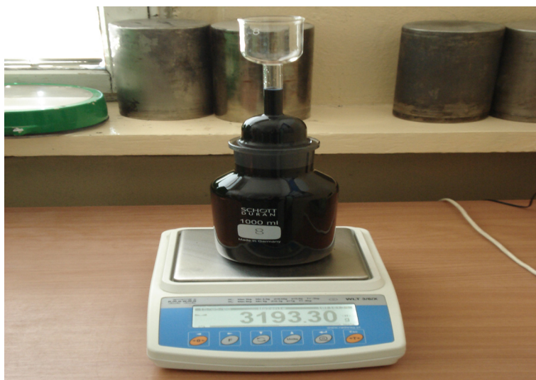
Rys. 1.14. Pomiar masy piknometru z próbką MMA i rozpuszczalnikiem
