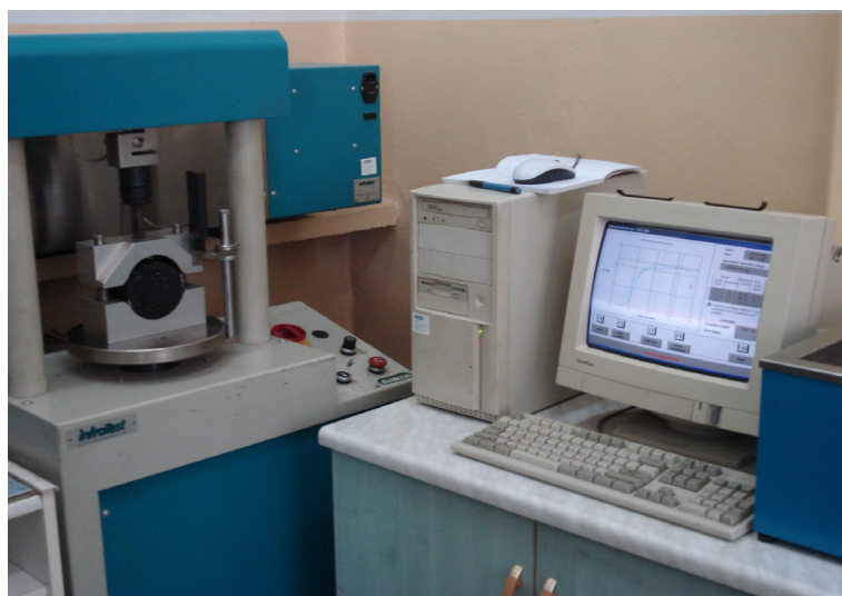
Rys. 1.13. Odczyt wyników odkształcenia i stabilności Marshalla
