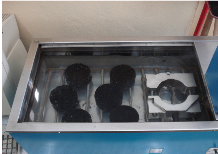
Rys. 1.11. Termostatowanie próbek Marshalla w łaźni wodnej
