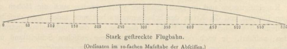
mit einem Kaliber von 11,5, geladen mit 3,5 g Pulver und einer Kugel von 21 g, die gestreckteste ein Schweizer-Schützen-Carabiner, bei einem Kaliber von 10,4, 16 g Kugelgewicht und 4 g Pulver.
