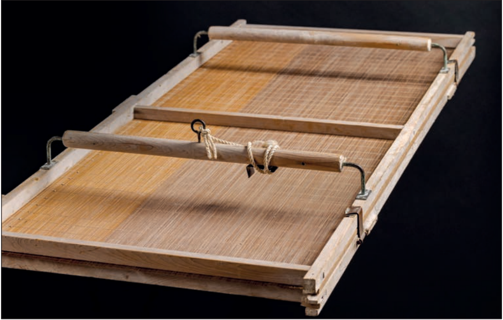
43. Rama sita do czerpania papieru wraz z włożonym sitem 43. 漉き簀の枠となる漉き杓 43. A papermaking mould and deckle with a screen
