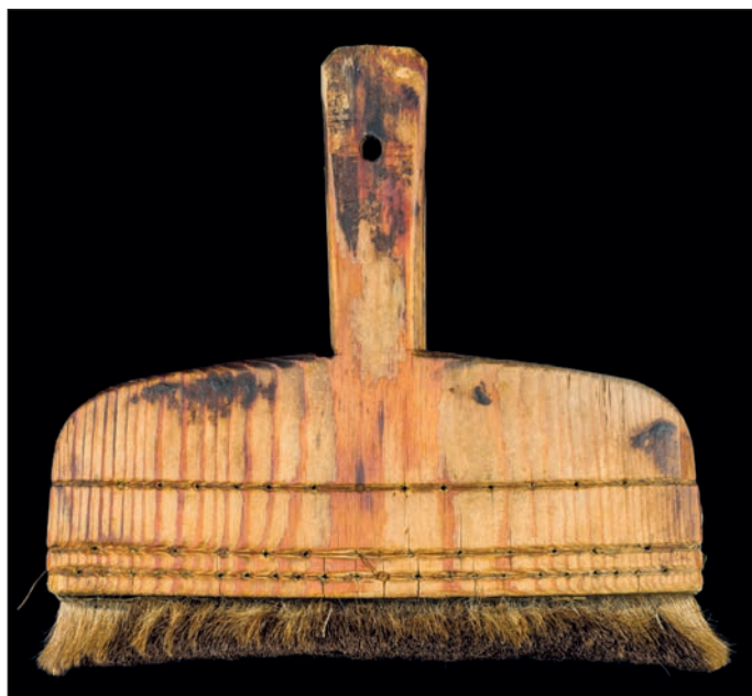
46. Pędzel do wygładzania mokrych arkuszy na desce 46. まだ湿った和紙を干し板に貼り付けるための刷毛 46. A brush for smoothing wet sheets on a drying board
