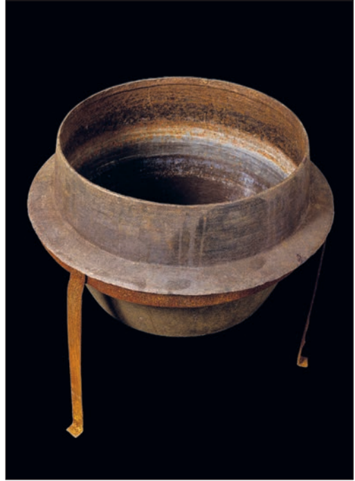
39. Kociołek do gotowania łyka w roztworze zasady 39. 靱皮をアルカリ液で煮るための釜 39. A cauldron for boiling fibres in an alkaline solution
