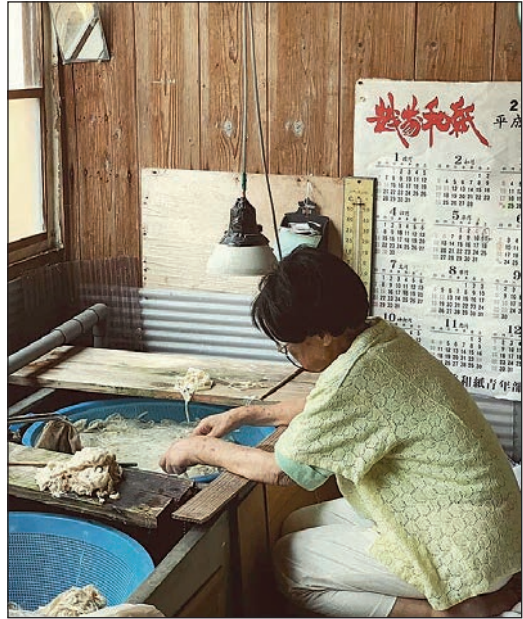
17. Pani Kinuko Yamaguchi podczas pracy – etap chiryori , czyli przebieganie włókien 17. 塵選りをしてきれいな繊維を用意している山口絹子さん 17. Mrs Kinuko Yamaguchi at work – the chiryori stage, or fibre cleaning
