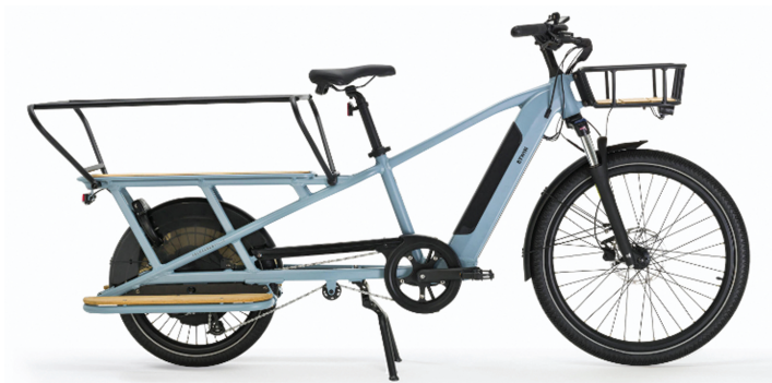
Rys. 5. Rower towarowy typu long tail
