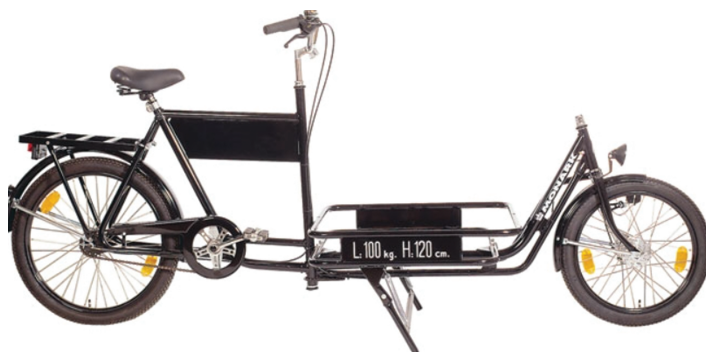
Rys. 4. Rower towarowy typu long john
