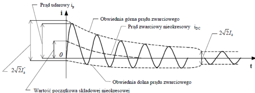
Rys. 8.5. Przykładowy przebieg prądu zwarciovego w przypadku zwarcia trójfazowego, odległego od źródła prądu zwarciovego [21]
