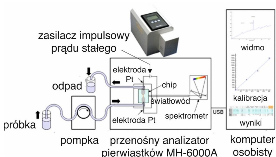
Rys. 2.16. Zasada działania urządzenia MH-6000A firmy Micro Emission (na podstawie [46]).
