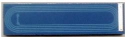
Rys. 3.9. Czujnik pola elektromagnetycznego do zastosowania w reaktorach typu Tokamak [57].
