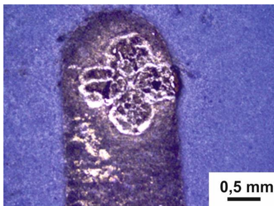
Rys. 5.4. Elektromigracja przelotek Ag do warstwy elektrody kontaktowej PdAg.
