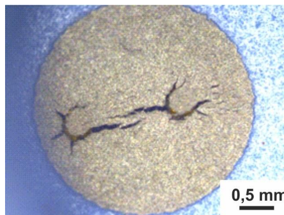
Rys. 5.5. Niedopasowanie „skurczu” materiałów przelotek Au oraz elektrody Pt.
