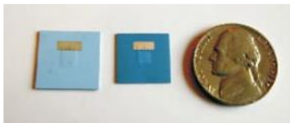
Rys. 3.21. Od lewej kolejno chip LTCC przed wypaleniem oraz po wypaleniu. Moneta dla skali [63].
