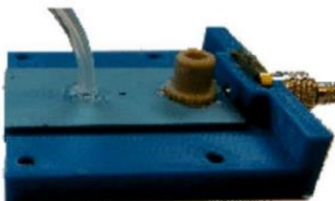
Rys. 3.17. Chip LTCC umieszczony w uchwycie polimerowych [12].
