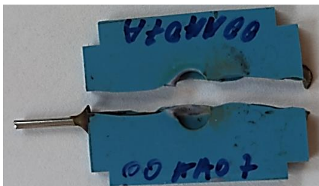
Rys. 4.18. Pęknięcie układu ceramicznego na dwie części.
