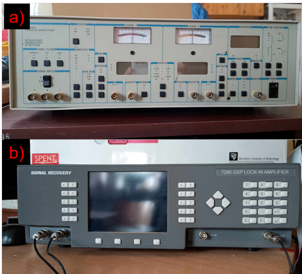
RYSUNEK 2.2: Wykorzystywane wzmacniacze fazoczułe: a) Stanford SR530 posiadający węższe pasmo pomiarowe, ale pozwalający na pomiar większych wartości napięcia oraz b) Signal Recovery 7280 DSP posiadający pasmo sięgające aż 2 MHz, ale ograniczenie wielkości sygnału wejściowego na poziomie 1 V.
