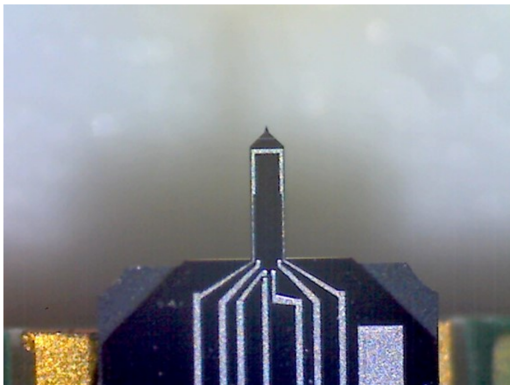
RYSUNEK 7.1: Zdjęcie badanej mikrobełki wykonane mikroskopem cyfrowym. U nasady widoczne jest miejsce do potencjalnego osadzenia piezorezystorów do detekcji ugięcia.
