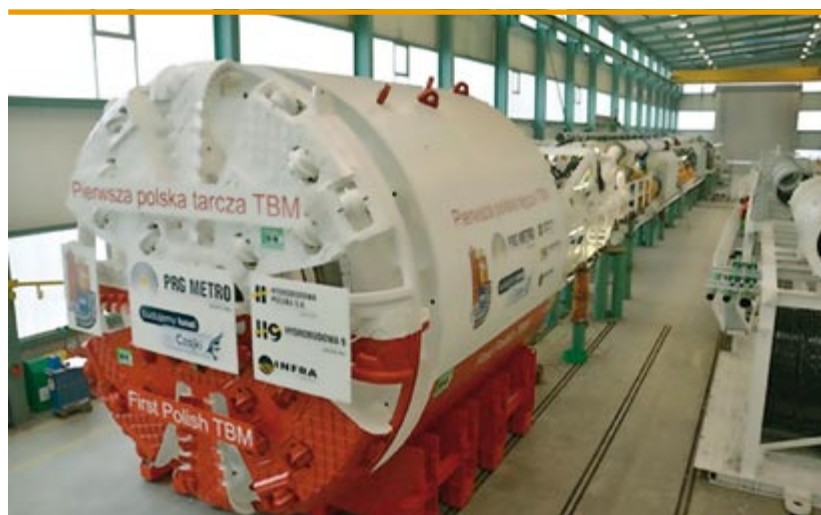
Pierwsza w Polsce nowoczesna tarcza zmechanizowana TBM do budowy tunelu pod Wisłą w Warszawie (inwestor MPWiK Warszawa)
