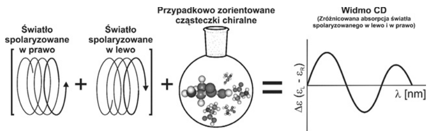
Rysunek 3. Widmo CD, jako wynik zróżnicowanej absorpcji promieniowania spolaryzowanego kołowo w lewo i w prawo
