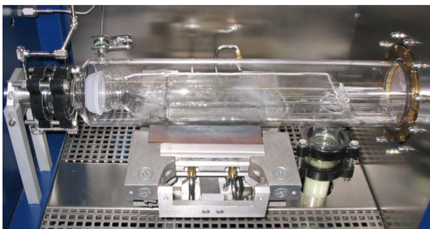
Rys. 87. Reaktor epitaksjalny AIX200 R&D firmy AIXTRON z modulem grzewczym.
