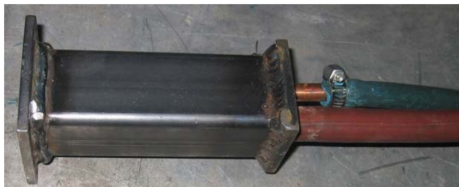
Rys. 11.18. układ chłodzenia podłączony do sieci wodnej
