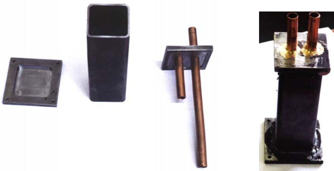
Rys. 11.17. Elementy układu chłodzenia oraz całkowity system chłodzący
