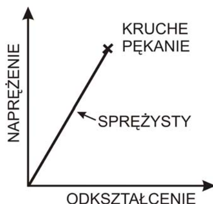
Rys. 5.4. Typowy wykres rozciągania materiałów ceramicznych z przełomem kruchym [72]
