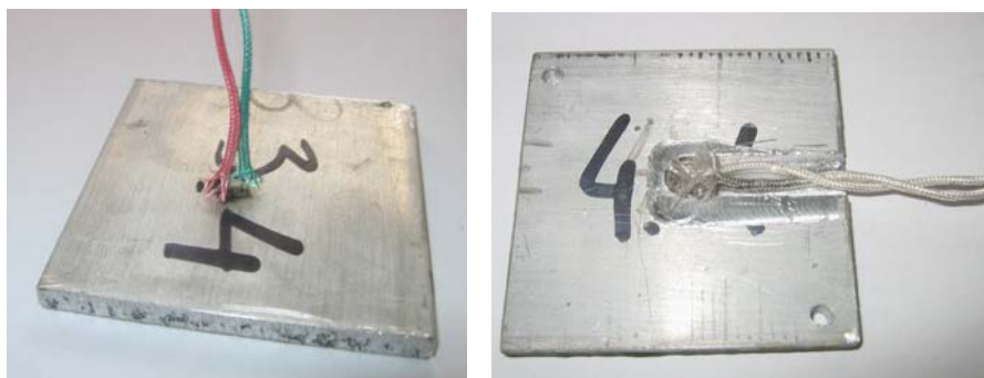
Rys. 11.25. Mocowanie termopar do próbek a) chłodzenie powietrzem b) chłodzenie wodą
