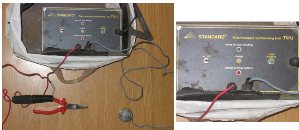
Rys. 11.24. Punktowa zgrzewarka TWU firmy Standard
