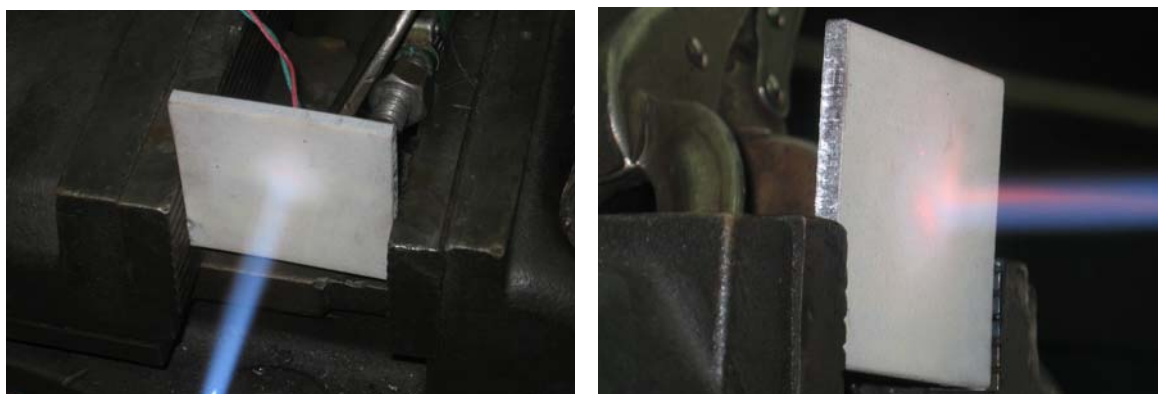
Rys. 11.27. Podgrzewanie płomieniem palnika próbki chłodzonej powietrzem
