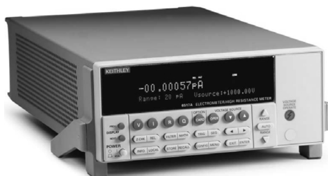
Rys. 7.4. Elektrometr Keithley 6517A wykorzystywany w układzie pomiaru rezystancji próbki.
