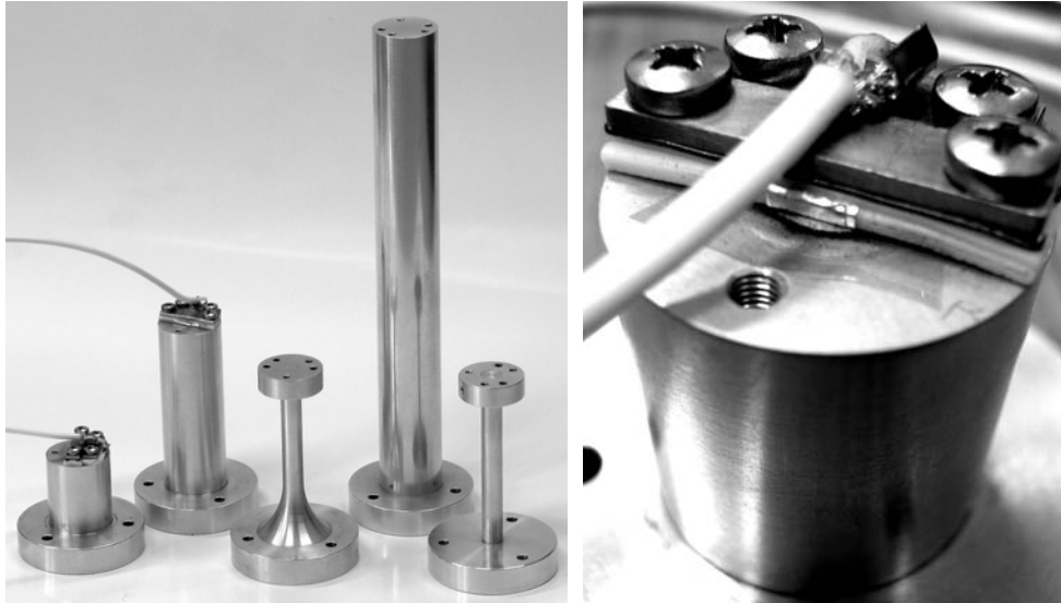
Rys. 7.14. Zdjęcie elektrod pomiarowych (z lewej) i widok sposobu mocowania czujnika (z prawej) dla czujnika krystalicznego \text{LiNbO}_3
