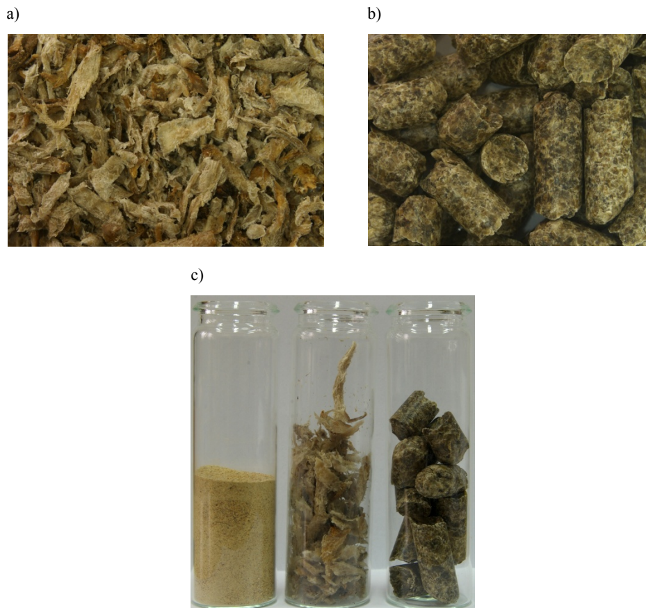
Rys. 2. Postacie wysłodków: a) wysłodki prasowane, b) wysłodki suche, c) od lewej: wysłodki suche zmielone, prasowane i suche
