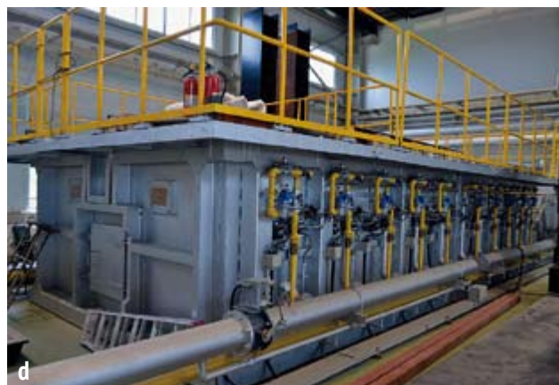
Wybrane elementy wyposażenia laboratorium SRC: a) ściana reakcyjna, b) stanowisko z siłownikami nośności 10 MN, c) platforma do obciążeń dynamicznych, d) piec do badań ogniowych
