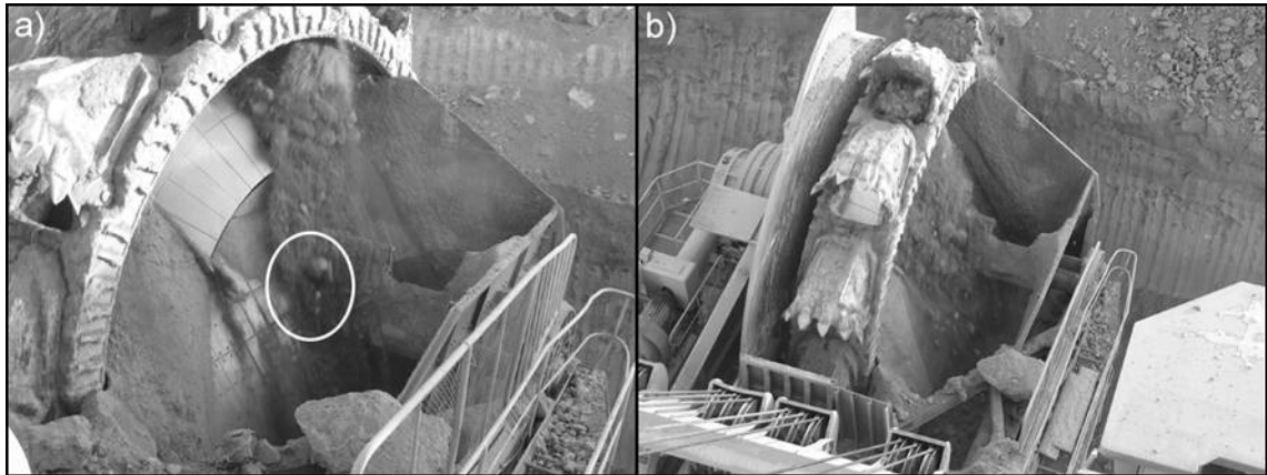
Rys. 161. Początkowa faza zsuwania się mas urobku po zsuwni koła czerpakowego koparki KWK-1500s (K-9). Górne położenie koła czerpakowego oraz maksymalne napełnienie czerpaka urobkiem. Ramką oznaczono powierzchnię styku urobku z zsuwnią w obszarze największych obciążeń dynamicznych: a) widok z podestu kabiny operatora, b) widok z podestu wiatromierza
