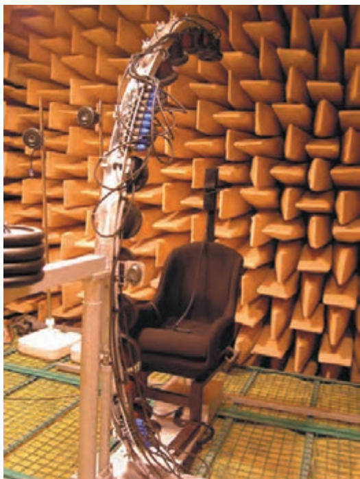
Urządzenie do badania zjawisk związanych z lokalizacją źródła dźwięku przez człowieka, opracowane w Pracowni w ramach prac badawczych związanych ze wspomaganiami osób słabowidzących i niewidzących, przez zespół w składzie: dr inż. P. Plaskota, dr inż. P. Pruchnicki, prof. A. Dobrucki
