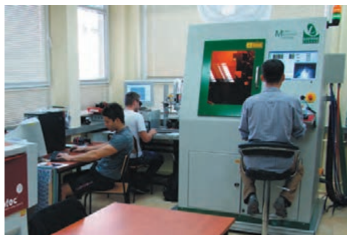
Laboratorium Mikroobrobki Laserowej – system do mikroobrobki z nanosekundowym laserem SSDPL 532 i 1064 nm
