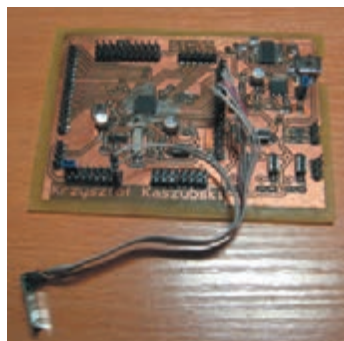
Jeden z prototypów dydaktycznego modułu uruchomieniowego z mikrokontrolerem STM32
