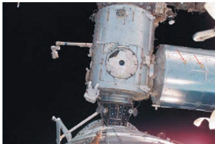
Moduł Columbus z antenami opracowanymi w Pracowni pod kierunkiem dr. hab. inż. Pawła Kabacika (antenę – zaznaczone strzałkami) (Fot. NASA)
