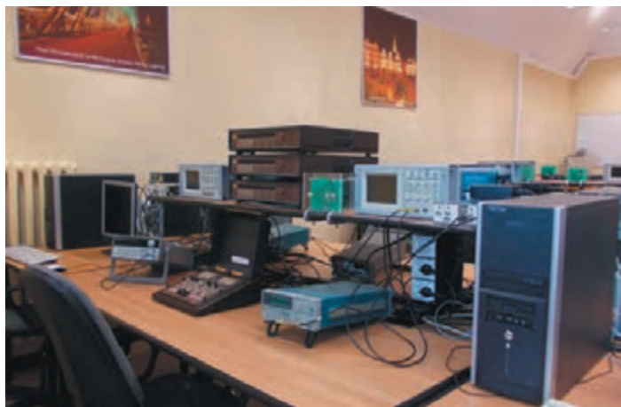
Stanowisko badawcze do pomiaru bardzo małych prądów w Laboratorium Fizycznych Podstaw Pomiaru
