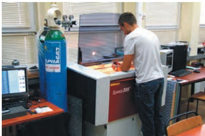
Ploterowy system z laserem CO 2 do obróbki: ceramiki, polimerów oraz materiałów organicznych
