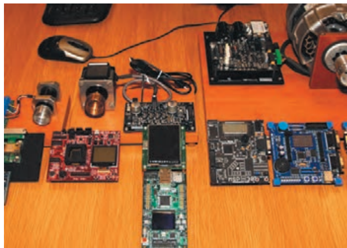
Wybrane moduły mikroprocesorowe używane w Laboratorium Mikrokontrolerów
