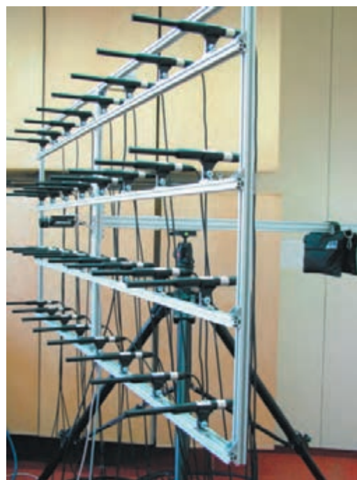
Matryca wielomikrofonowa opracowana i skonstruowana w Pracowni Podstaw Inżynierii Dźwięku
