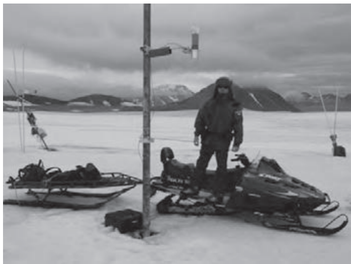
Mgr inż. Krzysztof Herman nadzoruje pracę ultradźwiękowego miernika poziomu warstwy śniegu na Spitsbergenie
