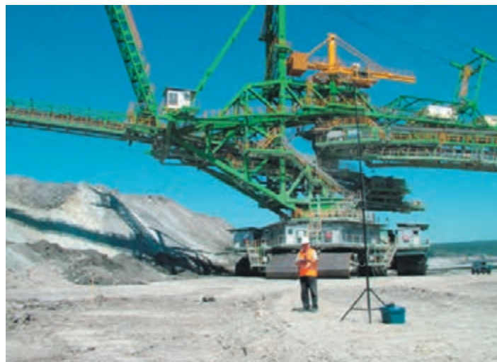
Badania hałasu maszyn górniczych w KWB Turów wykonuje mgr inż. J. Świerkowski
