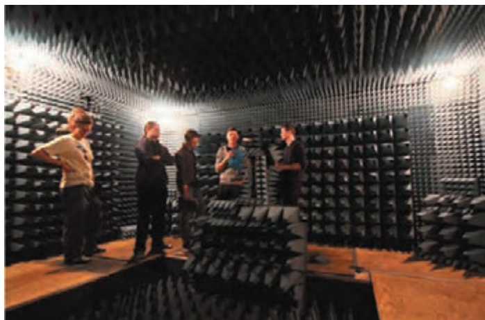
Laboratorium Techniki Antenowej – studenci w komorze bezodbiciowej Katedry Radiokomunikacji i Teleinformatyki
