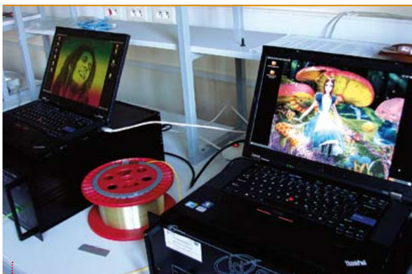
Zestaw kryptografii kwantowej na niesplątanych fotonach – na terminalach Alice i Boba szwajcarskiej firmy idQuantique, Alicja w krainie czarów i Bob Marley (w informatyce kwantowej przyjęto terminy Alice i Bob dla określenia stron kwantowej komunikacji, która może być utrudniana z kolei przez Eve ( eavesdropper ), choć to nie proste zadanie)
