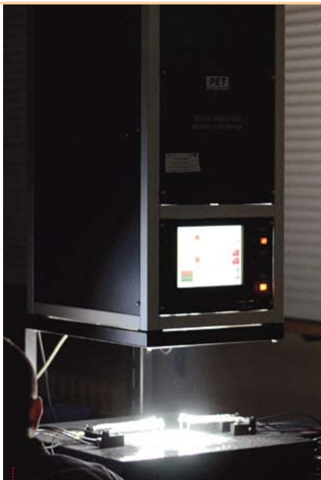
Sztuczne słońce w pracowni fotowoltaiki wiernie odtwarza spektrum naszej gwiazdy.
