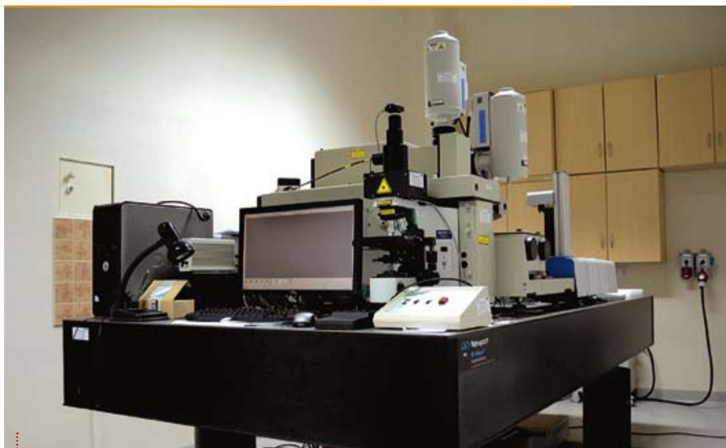
Na ponad półtonowym stabilizowanym stole spektrometr ramanowski firmy Horiba-Yvone-Jobin o wyjątkowych możliwościach pomiarowych, kwarcowa optyka pozwala na pracę także w ultrafiolecie.
