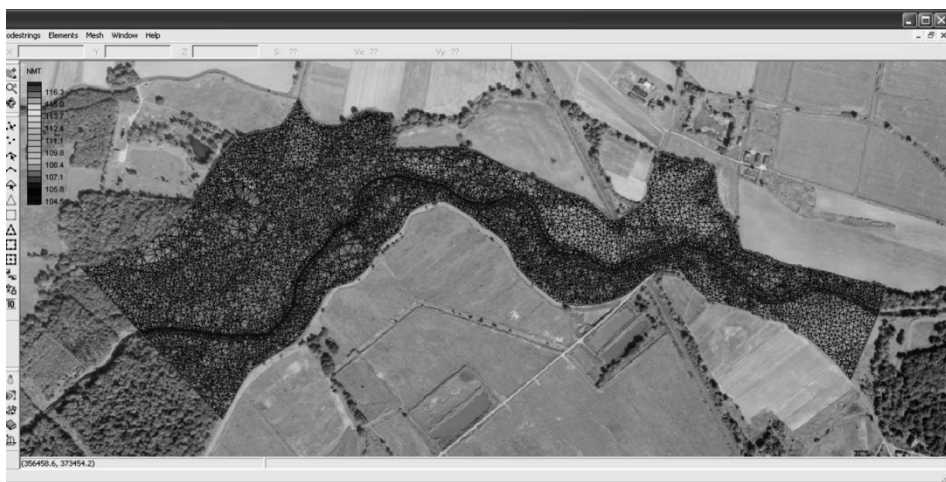
Rys. 2. Siatka dyskretyzacyjna utworzona na podstawie punktów NMT Fig. 2. Discrete mesh based upon DTM points
