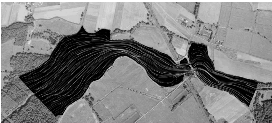
Rys. 3. Układ strug wody przy modelowanym przepływie Q=130 \text{ m}^3/\text{s}
