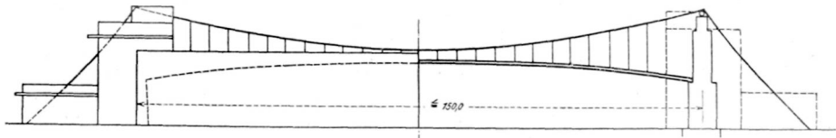
Abb. 20. u. 21. Binderformen mit Hängekabel und Kragbock für Sporthallen 1)
