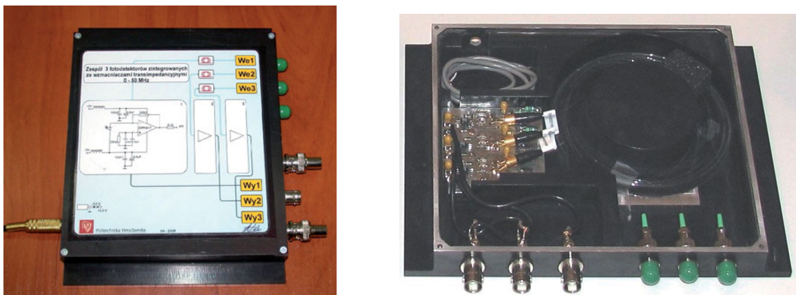
Rys. 3.11. Zespół trzech fotodetektorów ze wzmacniaczami transimpedancyjnymi.
