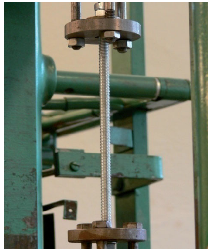
Rys. 4.50. Próbkę pręta gwintowanego w maszynie wytrzymałościowej podczas próby rozciągania.
