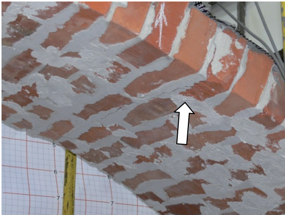
Rys. 4.80. Zarysowanie pod miejscem przyłożenia obciążenia (siła ok. 3 kN).
