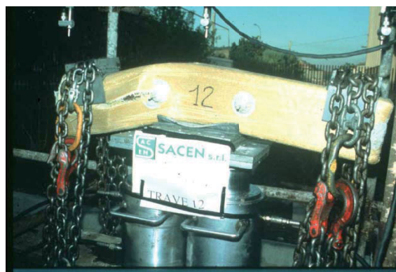
Rys. 3.105. Zniszczenie modelu żeber drewnianych wzmocnionych AFRP, [60].
