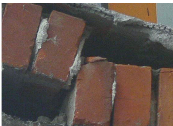
Rys. 6.4. Ścięcie połączenia między ceglami połączone z obrotem.
