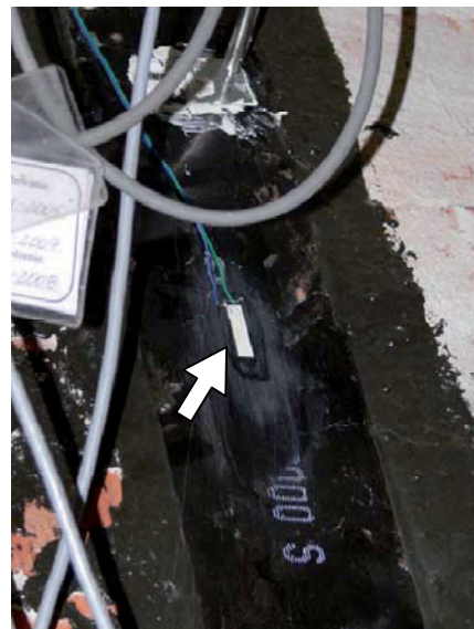
Rys. 4.162. Tensometr elektrooporowy na taśmie CFRP w łuku A6.
