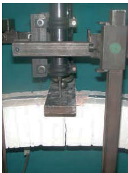
Rys. 3.134. Łuk n3 w fazie zniszczenia, [17].
