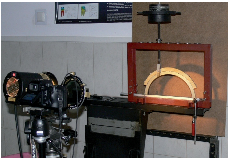
Rys. 4.207. Model wzmocnionego łuku A7 na stanowisku do badań elastoptycznych.
