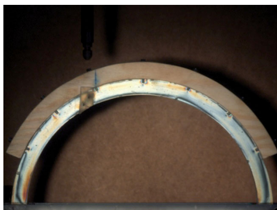
Rys. 4.212. Izochromy całkowite F = 0 , napięte kotwy.
