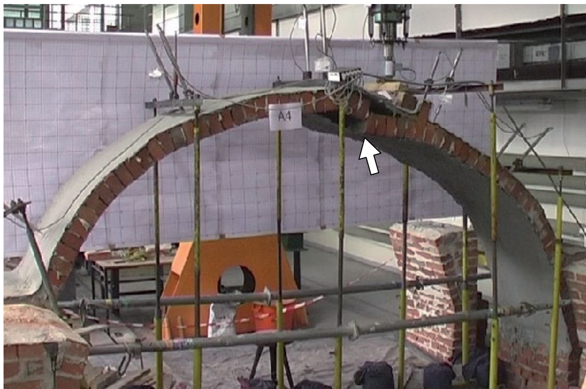
Rys. 4.136. Schemat zniszczenia łuku A4 – zaznaczony powstały przegub (siła 26,368 kN).
