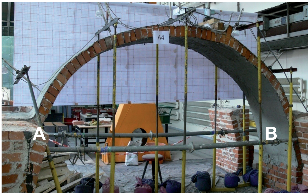
Rys. 4.123. Łuk A4 – widok ogólny (opisane podpory A i B).
