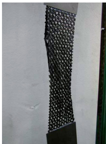
Rys. 3.19. Zniszczenie próbki nr 8.
