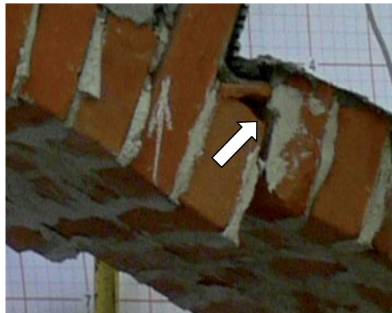
Rys. 4.83. Zmiażdżenie cegieł po stronie grzbietowej w obszarze przyłożenia obciążenia (siła 10,866 kN).
