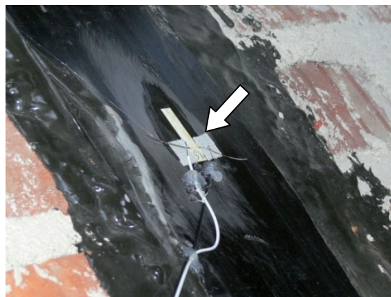
Rys. 4.100. Tensometr elektrooporowy na taśmie FRP w łuku A3.
