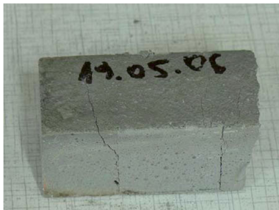
Rys. 4.30. Próbkę nr c3.1 – po zniszczeniu.
