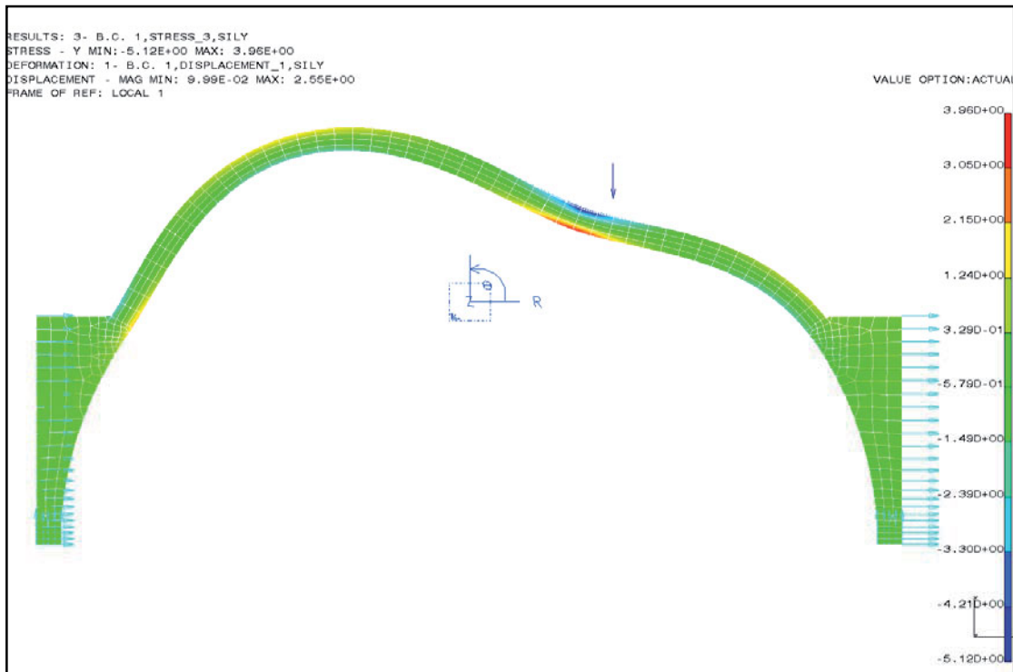
Rys. 4.61. Deformacje w łuku A1 - wyniki z obliczeń MES (I-Deas) (skala zniekształcona).
