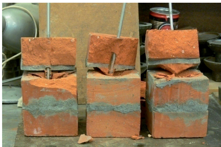
Rys. 4.55. Postać zniszczenia połączenia „pręt stalowy – klej – mur”.
