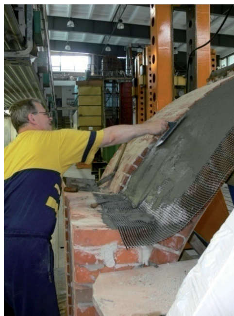
Rys. 4.77. Naklejanie siatki z włókna węglowego na łuk A2.
