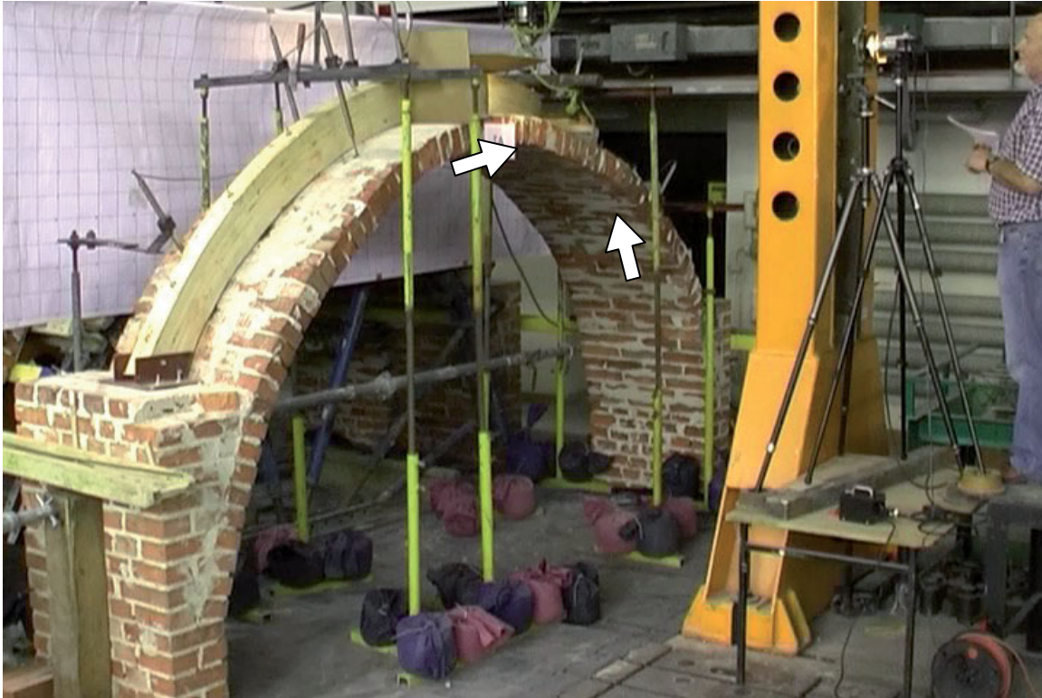
Rys. 4.202. Schemat zniszczenia łuku A7 (siła 27,618 kN).
