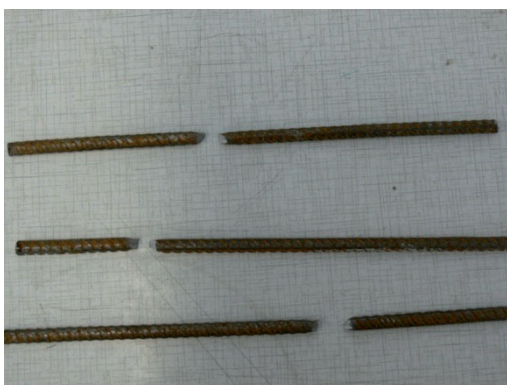
Rys. 4.51. Próbki prętów żebrowanych po zniszczeniu.
