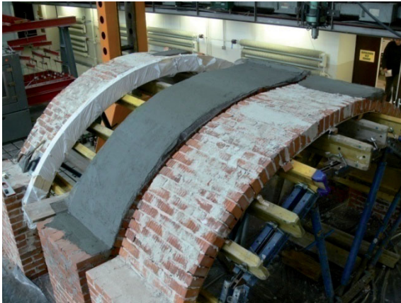
Rys. 4.78. Widok ogólny łuku A2 (łuk środkowy) z naklejoną siatką z włókna węglowego.
