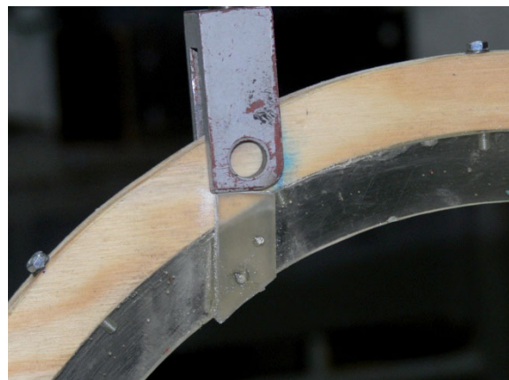
Rys. 4.209. Szczegół wykonania punktu przyłożenia obciążenia w łuku A7.
