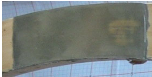
Rys. 4.214. Optyczna warstwa powierzchniowa naklejona na wzmocnienie łuku A7.
