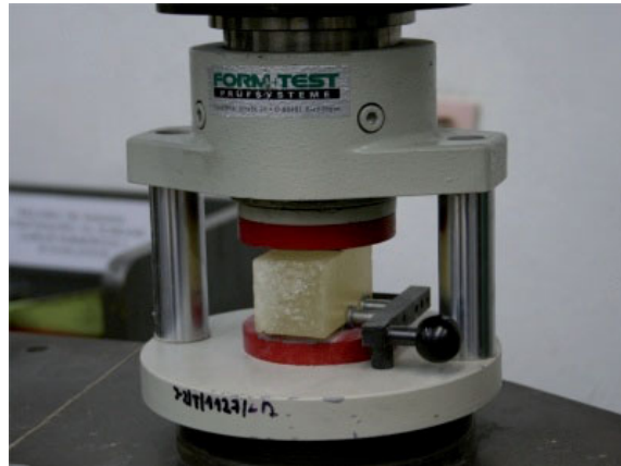
4.46. Badanie wytrzymałości kompozycji klejowej na ściskanie wg. [191].
