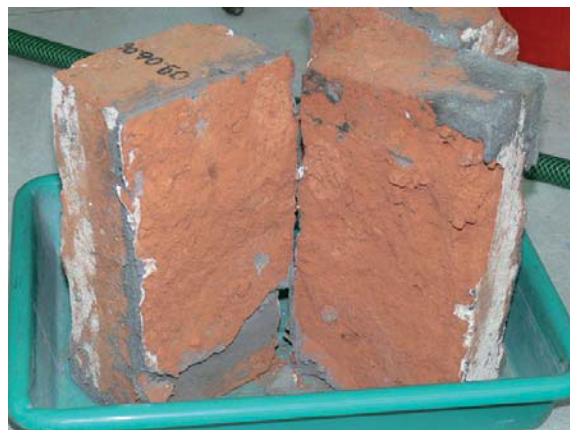
Rys. 4.43. Próbkę s3 – sposób zniszczenia.
