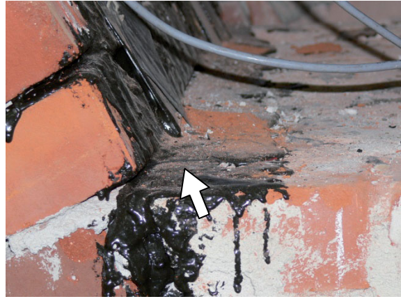
Rys. 4.164. Odspojenie kleju i taśmy CFRP od podpory 'B' (siła ok. 9,5 kN).
