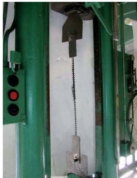
Rys. 3.23. Zniszczenie wiązki nr 10.
