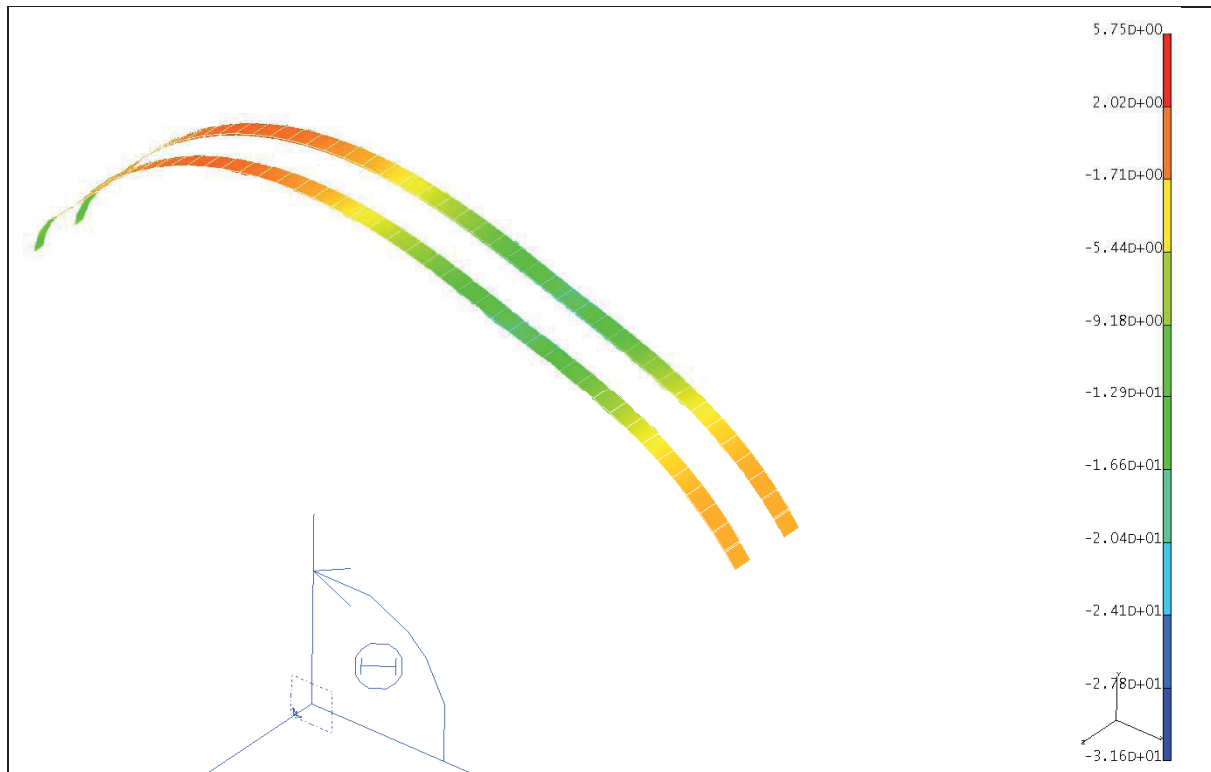
Rys. 5.27. Rozkład naprężeń obwodowych " \sigma_r " [MPa] w taśmach CFRP w łuku A3 – poziom obciążenia – 1kN.
