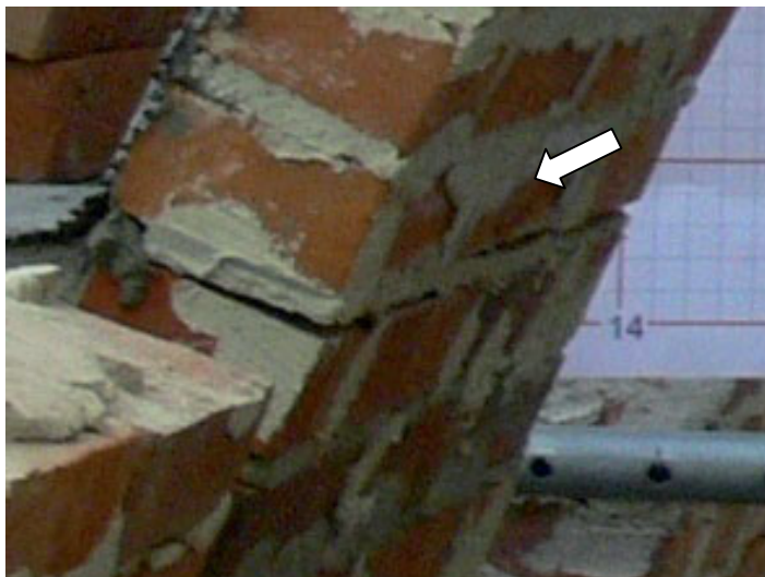
Rys. 4.84. Przegub na podporze lewej 'A' (siła 10,866 kN).
