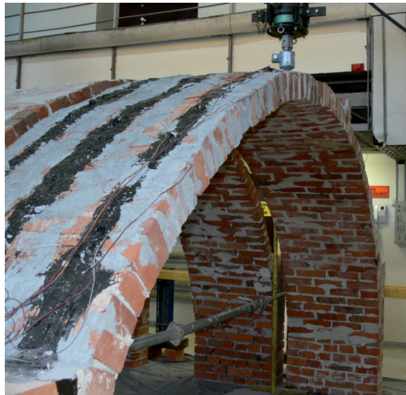
Rys. 4.145. Gotowe wzmocnienie w łuku A5.
