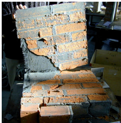
Rys. 3.148. Fragment muru ceglanego wzmocnionego FRCM.
