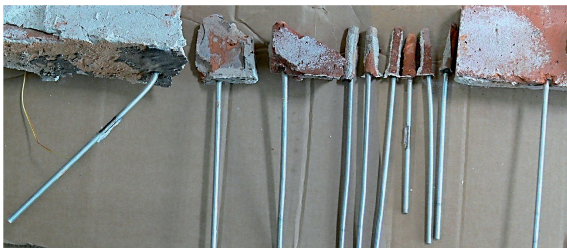
Rys. 4.194. Kotwy łączące wzmocnienie w drewna klejonego w łukiem A7 – widok po zniszczeniu.
