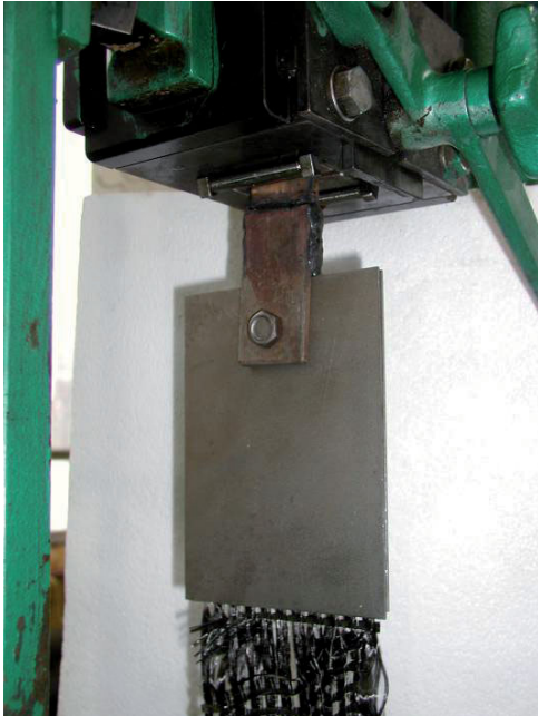
Rys. 3.9. Mocowanie siatki w płytach stalowych.
