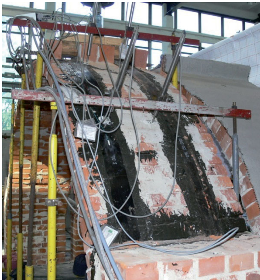
Rys. 4.161. Łuk A6 wraz z czujnikami przemieszczeń.
