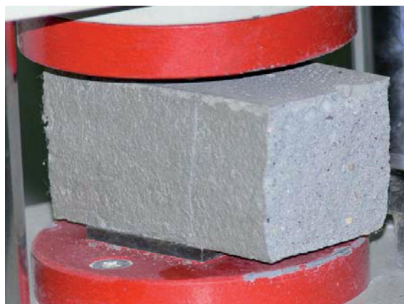
Rys. 4.28. Badanie wytrzymałości na ściskanie – próbka nr c2.1 – w trakcie niszczenia.
