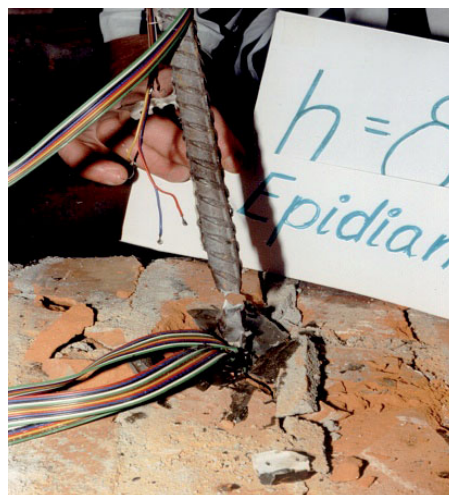
Rys. 3.92. Zniszczenie połączenia, kompozycją E – Epidian 5, [123].
