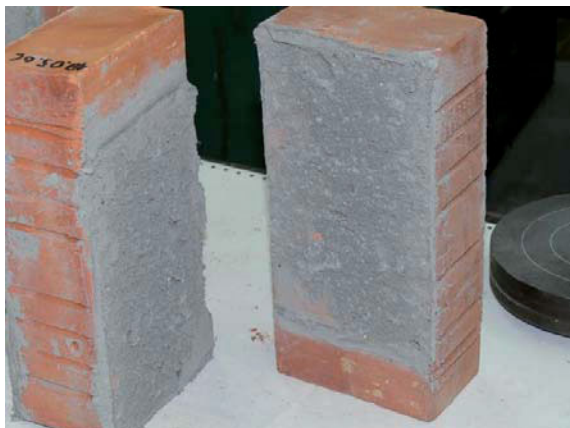
Rys. 4.40. Próbkę s1 – sposób zniszczenia.
