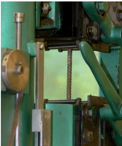
Rys. 4.49. Próbkę pręta żebrowanego w maszynie wytrzymałościowej podczas próby rozciągania.
