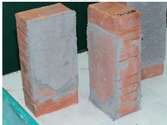
Rys. 4.41. Próbkę s1 – sposób zniszczenia.
