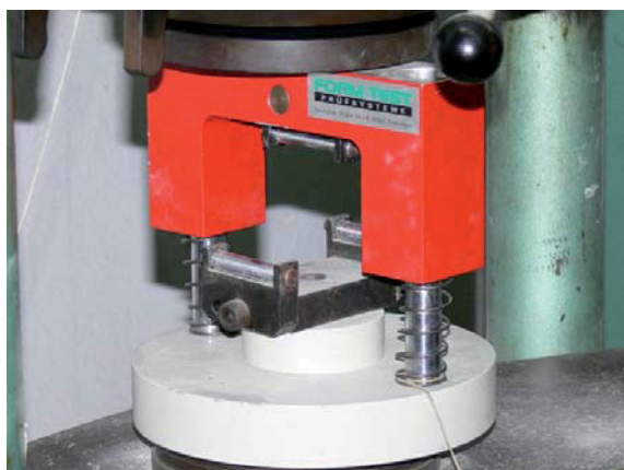
Rys. 4.6. Przystawka do badania wytrzymałości na zginanie w prasie mechanicznej wg [193].
