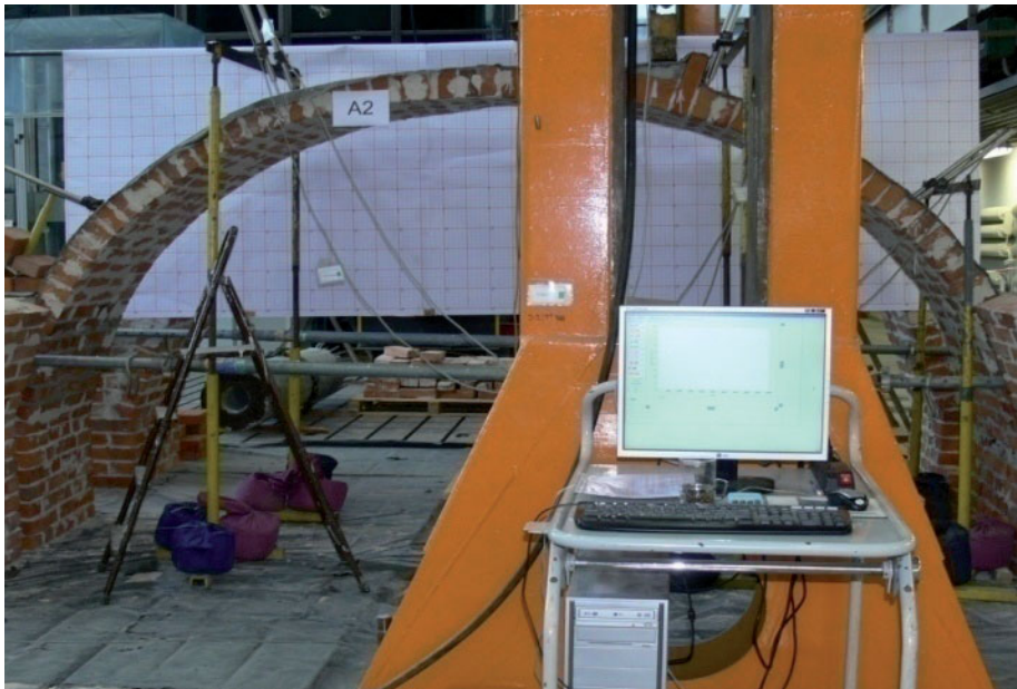
Rys. 4.59. Zestaw komputerowy do pomiaru siły, przemieszczeń oraz odkształceń.
