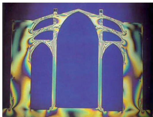
Rys. 3.186. Model przekroju katedry. gotyckiej podczas badań elastooptycznych [159].
