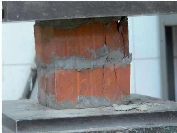
Rys. 4.4. Badanie wytrzymałości na ściskanie – próbka nr c1 w trakcie niszczenia.
