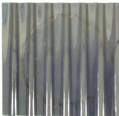
Rys. 10.4 Stan warstwy emalierskiej importowanej po testach korozyjnych.
