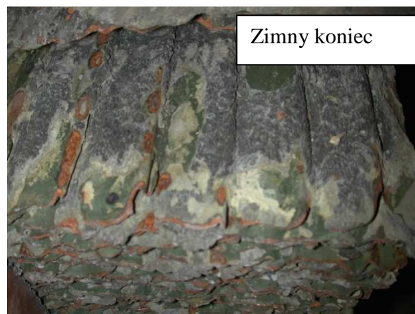
Rys. 11.18. Widok koszy grzewczych z blachami z warstwami malarskimi.
