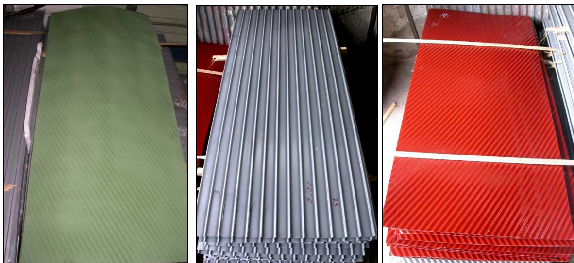
Rys. 11.17. Widok na fragment blachy z powłoką S-Coating, Hempalin Hold oraz Temaline
