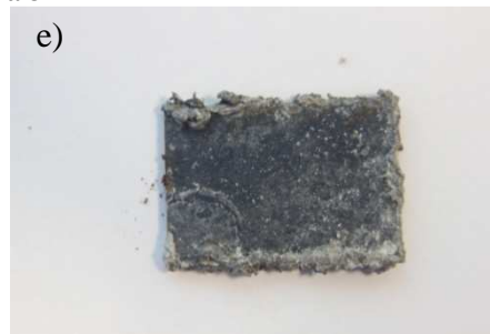
Rys. 11.8. Widok ogólny wybranych próbek po badaniach korozyjnych: (a,c,e) z warstwą soli na powierzchni, (b,d,f) po oczyszczeniu wodą destylowaną.
