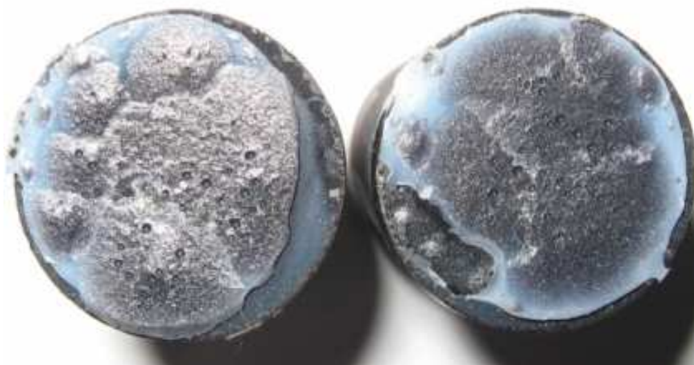
Rys.11.13. Próbką emaliowana PP40846S po badaniu wytrzymałości na rozciąganie.
