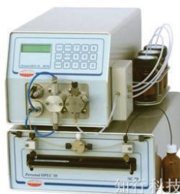
Rysunek 18. Urządzenie do chromatografii planarnej ciśnieniowej, Personal OPLC Basic System 50 [48]
