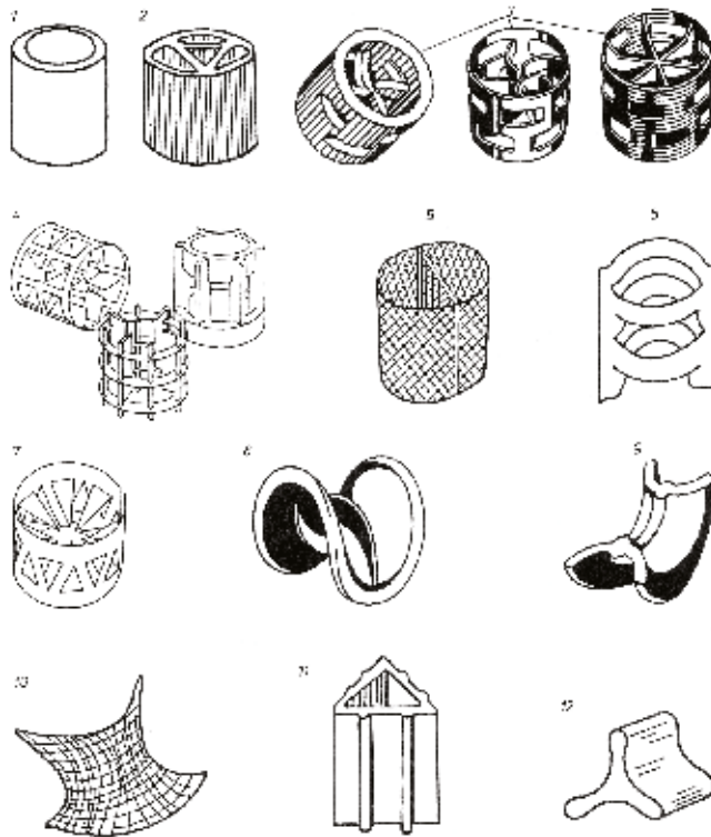
Rys. V. 19. Wypełnienia usypane [4] 1 – pierścień Raschiga, 2 – pierścień z przegrodami, 3 – pierścień Palla, 4 – pierścień Hiflow, 5 – pierścień siatkowy, 6 – element Interpack, 7 – pierścień Białeckiego, 8 – siodełko Berla, 9 – siodełko Intalox, 10 – siodełko MacMaham, 11, 12 – inne kształtki
