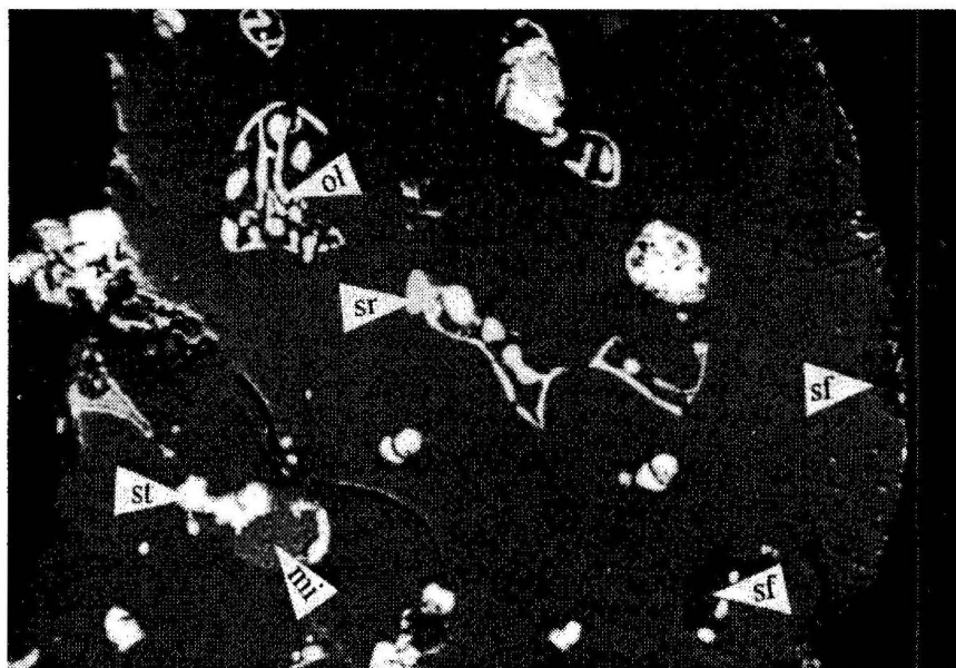
Rys. 5. Struktury z odmieszania: ołowiu (ol), srebra (sr), miedzi (mi), sfalerytu (sf) i stopu Pb–Cu (st) w bornicie. Mikroskop skaningowy, zdjęcie fazowe. Podziałka 0,1 mm
