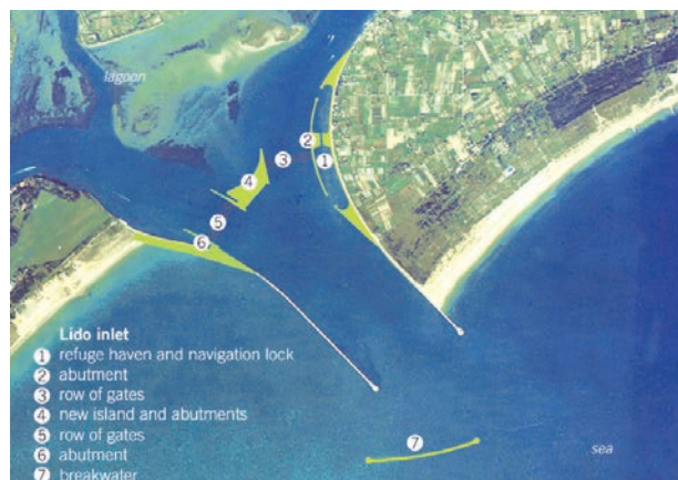
Il. 7. Cieśnina Lido z zaparami (autor: Magistrato alle Acque di Venezia – Consorzio Venezia Nuova [CC BY-SA 3.0], http://commons.wikimedia.org/wiki/File:Lido_progetto_GB.jpg?uselang=pl )
