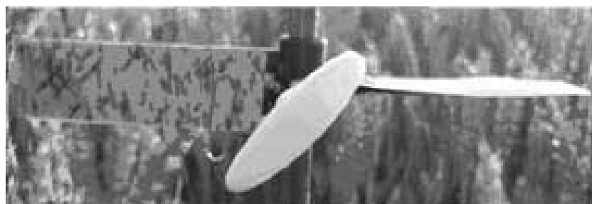
Rys. 2. Zamocowanie papierków wodoczułych na sztucznej roślinie w łanie pszenicy Fig. 2. Water-sensitive paper fastening to an artificial plant on wheat field
