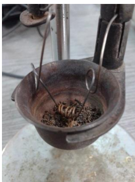
Rys. 3. Pomiar zawartości chloru: (a) zmontowana bomba kalorymetryczna, (b) stała pozostałość po spaleniu paliwa w bombie kalorymetrycznej, (c) elektroda jonoselektywna chlorkowa (na ramieniu multimetru od lewej – termometr, mieszadło oraz elektroda podwójna, z podwójnym płaszczem)
