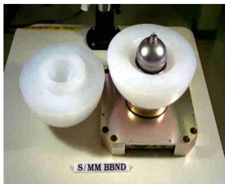
Rys. 4. (a) Kula Bonnera [6], (b) Schemat detektora gazowego [6]
