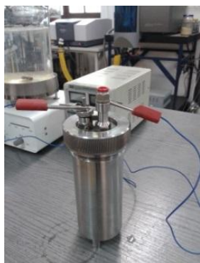
Rys. 3. Pomiar zawartości chloru: (a) zmontowana bomba kalorymetryczna, (b) stała pozostałość po spaleniu paliwa w bombie kalorymetrycznej, (c) elektroda jonoselektywna chlorkowa (na ramieniu multimetru od lewej – termometr, mieszadło oraz elektroda podwójna, z podwójnym płaszczem)
