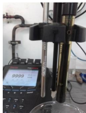
Rys. 3. Pomiar zawartości chloru: (a) zmontowana bomba kalorymetryczna, (b) stała pozostałość po spaleniu paliwa w bombie kalorymetrycznej, (c) elektroda jonoselektywna chlorkowa (na ramieniu multimetru od lewej – termometr, mieszadło oraz elektroda podwójna, z podwójnym płaszczem)
