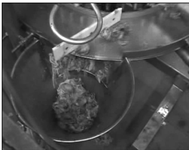
Rys. 9.9. Urządzenie podciśnieniowe do transportu ubocznych artykułów uboju [64]
