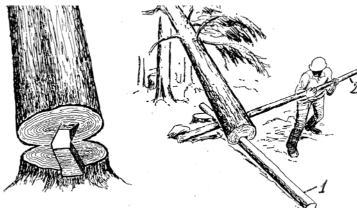
Rys. 8.16. Ściąganie drzew o miąższości do 0,5 m 3 [Chainsaws 1980]: a – za pomocą dwukółki zrywkowej, b – za pomocą dwóch drążków; jednego użytego jak prowadnicę (1), a drugiego – jak dźwignię (2)
