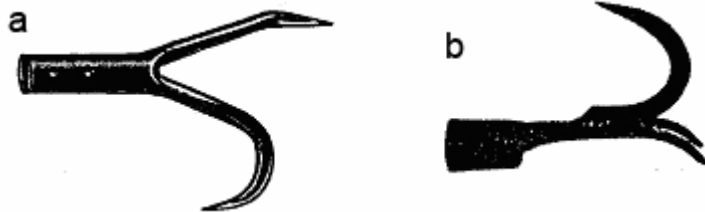
Rys. 2.14. Haki do tyczek kierunkowych [katalog]: a – odstęp kolców – 13 cm, masa – 1 kg, b – masa ~ 1,2 kg
