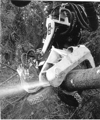
Rys. 12.41. Głowice ścinkowo-okrzesujące do harwesterów Timberjack [reklama]: H742, b – 745, c – H754, d – 758
