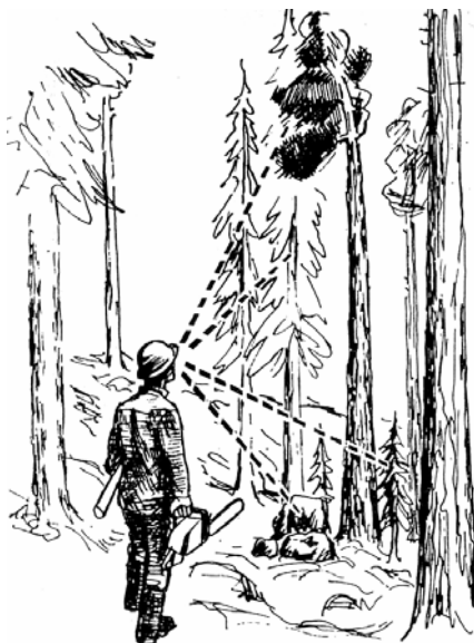
Rys. 8.2. Ocena warunków ścinki do wyboru wariantu i indywidualnego kierunku obalania [Lindberg, Skaaret 1966]
