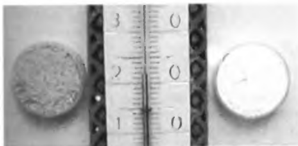
Rysunek 11 Zdjęcie potwierdzające bistabilność kompleksu [\text{Fe}(\text{NH}_2\text{trz})_3](\text{CH}_3\text{SO}_3)_2 w temperaturze pokojowej 22°C (295K)
