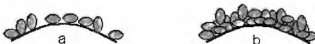
Rysunek 5. Wiązanie enzymu z powierzchnią nośnika przez prostą adsorpcję (a) lub depozycję/agregację (b)
