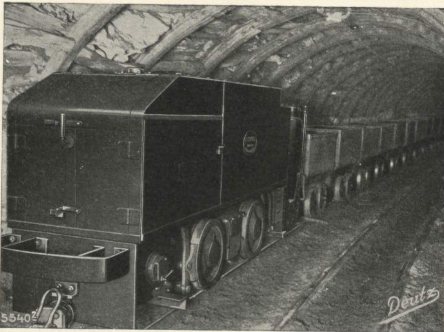
Abb. 2. Diesel-Grubenlokomotive der Humboldt-Deutz-Motoren A.-G. 26 PS; 7 t Dienstgewicht
