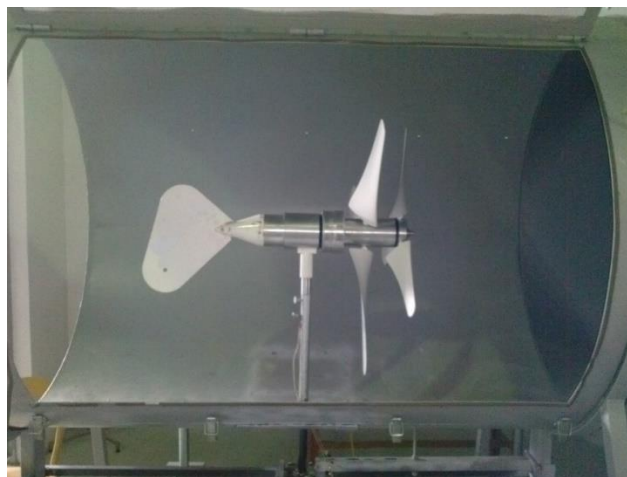
rys. 25. Dwuwirnikowa mini elektrowni wiatrowa zamontowana w komorze pomiarowej
