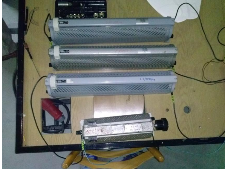
rys. 36. Rezystory suwakowe o wartościach rezystancji 2,35 \Omega ; 2,35 \Omega ; 9 \Omega ; 13 \Omega
