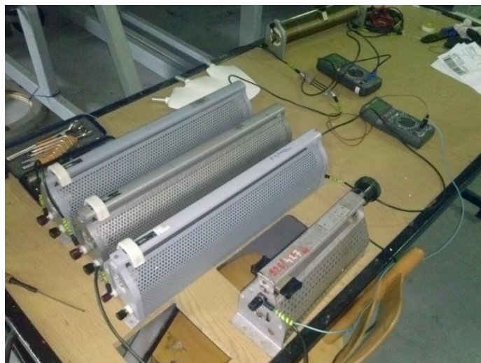
rys. 41. Układ pomiarowy mini elektrowni wiatrowej
