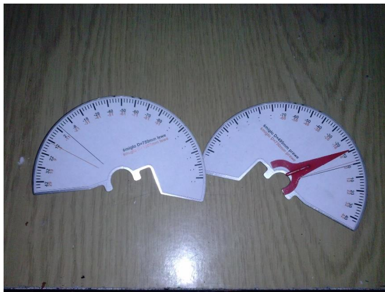
rys. 40. Specjalistyczne kątomierze do ustawienia kąta zaklinowania łopat
