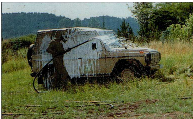
Zdj.2. Nakładanie na skażone powierzchnie gorącej piany lub emulsji
