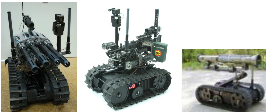
Rys. 3. TALON uzbrojony w: (od lewej) 40 mm granatnik Metal Storm, następnie 7,62 mm (opcjonalnie 5,56 mm) karabinek, i wyrzutnię PPK AT-4.
