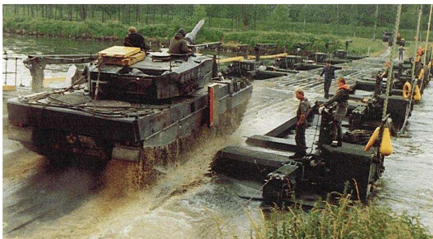
Rys. 2. Samobieżny park mostowo-promowy M3 a) amfibia M3 w położeniu transportowym b) odcinek mostu z M3 i rampami wjazdowymi c) przeprawa po moście z M3 pod obciążenie MLC70
