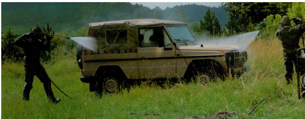
Zdj.1. Wstępne zmywanie zanieczyszczeń z pojazdów
