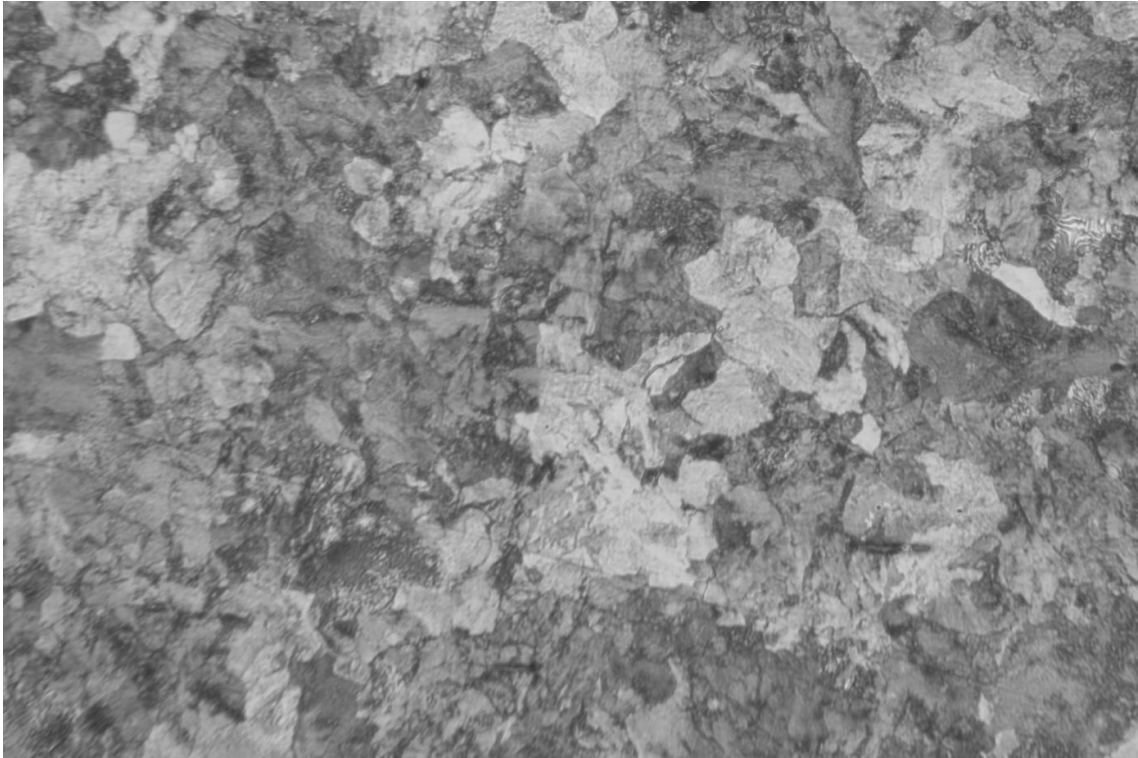
Rys. 8.3. Zdjęcie mikrostruktury stali EA4T w powiększeniu \times 200
