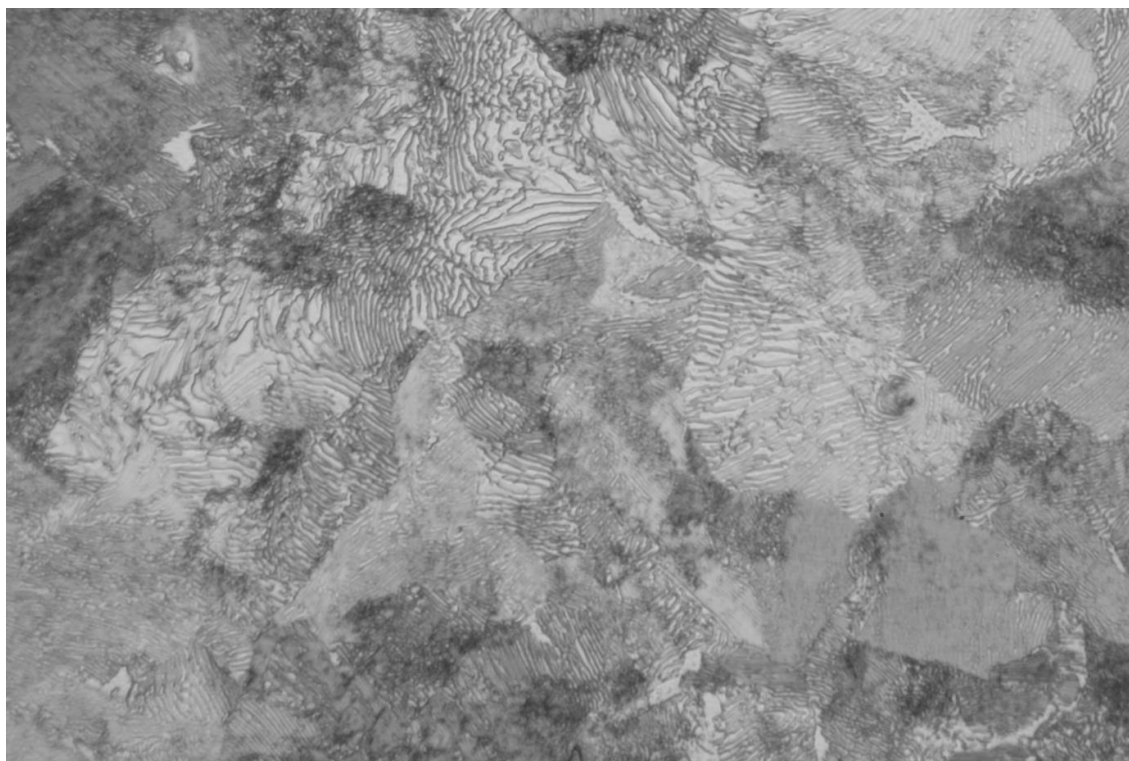
Rys. 8.2. Zdjęcie mikrostruktury stali EA4T w powiększeniu \times 500
