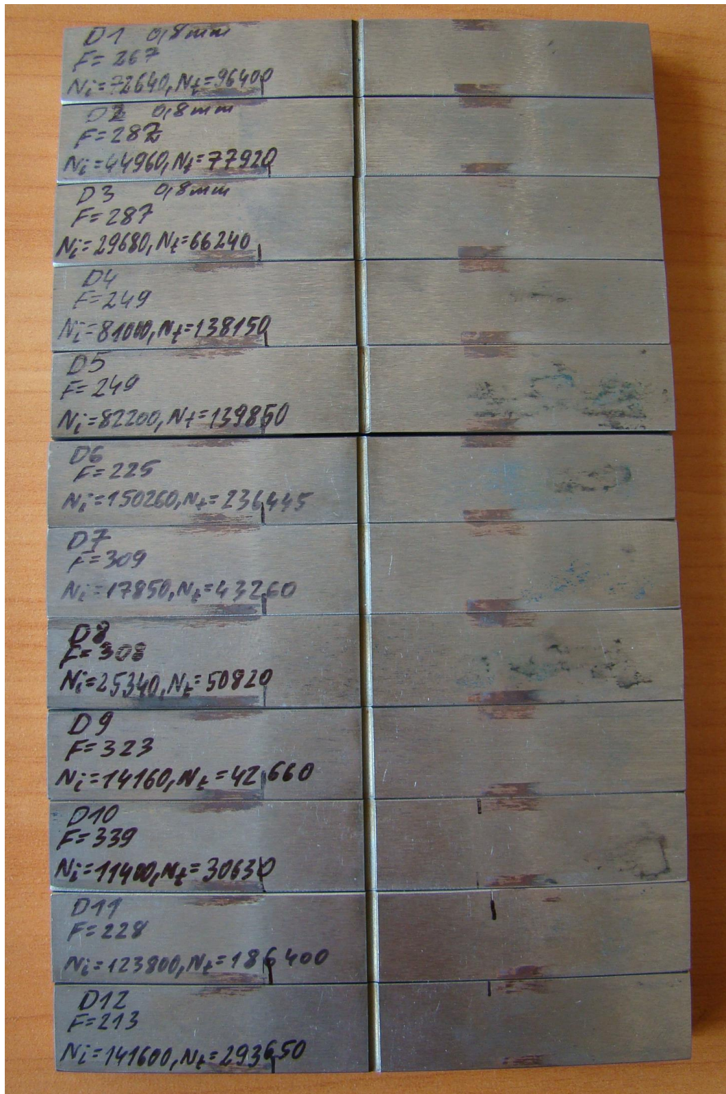
Rys. Z6. Próbkki z karbem R = 0,8 mm ze stali 42CrMo4+QT
