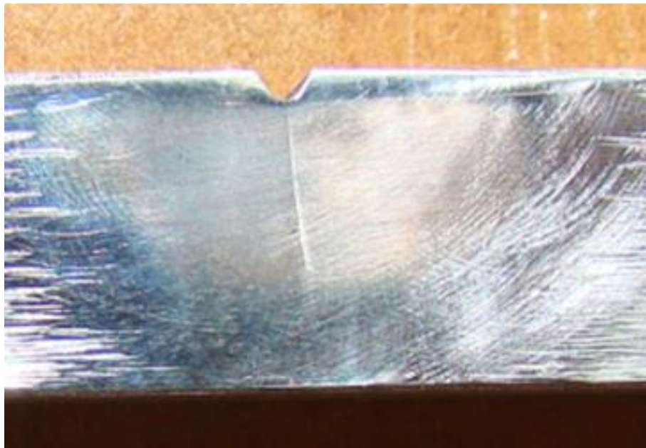
Rys. 9.23. Płaszczyzna propagacji pęknięcia w zginanych próbkach ze stali 42CrMo4+QT
