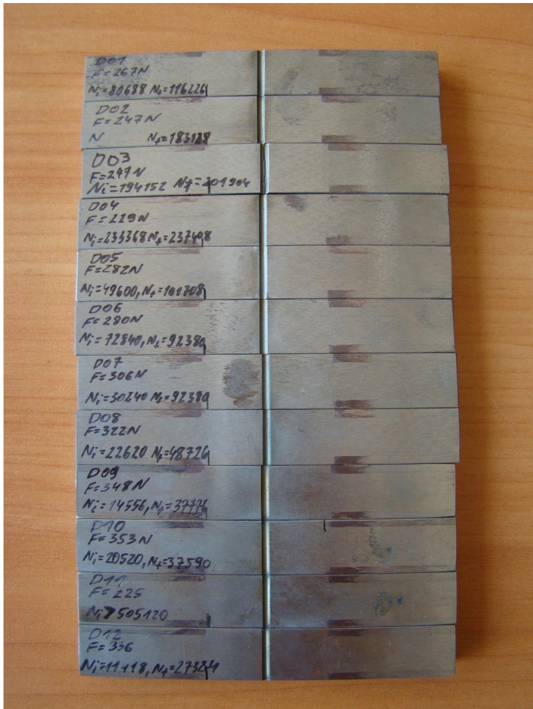
Rys. Z7. Próbkki z karbem R = 1 mm ze stali 42CrMo4+QT (D11 nieuwzględnione w charakterystyce)
