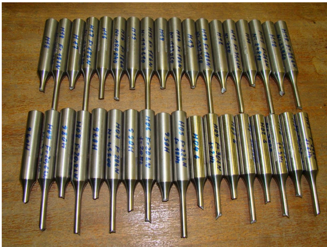
Rys. Z3. Próbkki gładkie ze stali 42CrMo4+QT
