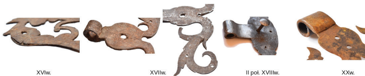
Il. 7. Materiałowe zmiany jakościowe od XVI-wiecznego kowalsko zgrzewanego żelaza po współczesną wycinaną i spawaną stal (oprac. R. Karnicki)
