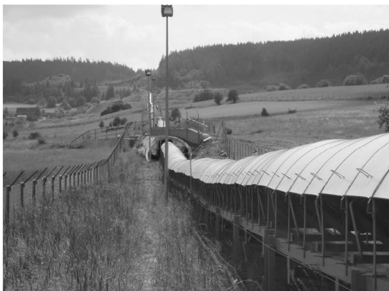
Rys. 2. Transport melafiru ze złoża „Świerki” przenośnikiem taśmowym (źródło: Siemens) Fig. 2. Melaphyre belt conveyor from “Świerki” deposit (source: Siemens)
