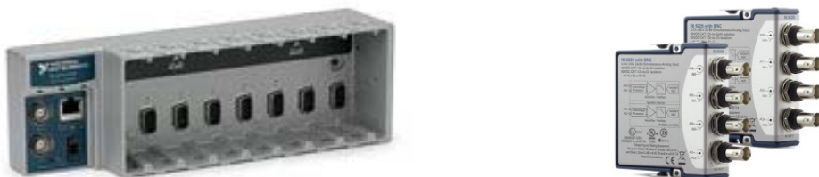
Rys. 2. Kasetka Compact DAQ z modułami NI WLS 9215 Fig. 2. Compact DAQ chassis with NI WLS 9215 modules.
