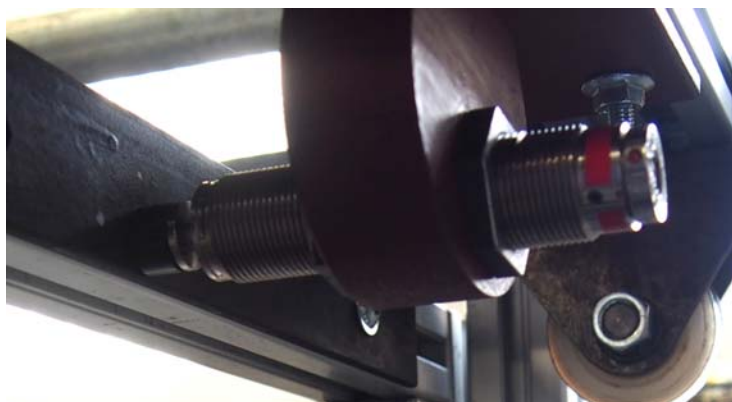
Rys. 7. Widok zabudowanego regulowanego tłumika dynamicznego Fig. 7. View of installed adjustable damper
