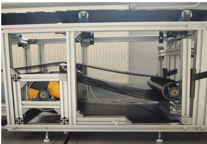
Rys. 4. Proporcjonalny, nadążny układ napinania taśmy w Laboratoryjnym Modelu Przenośnika Taśmowego
