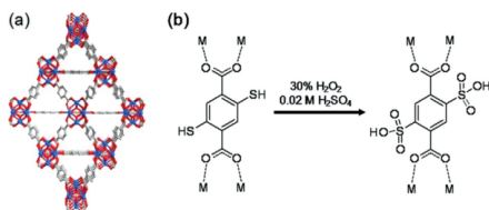
Rysunek 9. a) Struktura krystaliczna sieci UiO-66(SH) 2 ; b) Schemat postsyntetycznej modyfikacji UiO-66(SH) 2 , przeprowadzonej w celu wprowadzenia kwaśnych grup sulfonowych. Rysunek zaczerpnięto z ChemPlusChem, 2016, 81 , 691 za zgodą Wiley Online Library [9]
